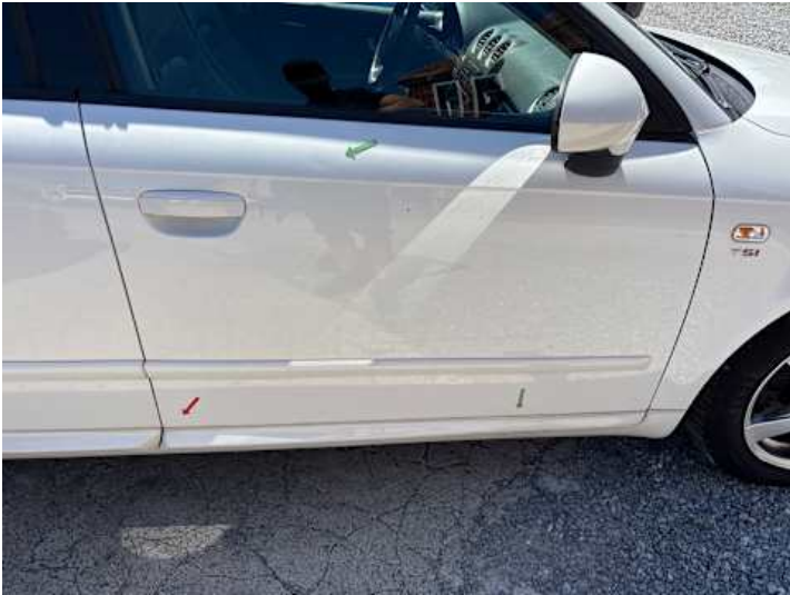
Beifahrer ­ t ­ ur (Kratzer, Lackschaden, Delle)
