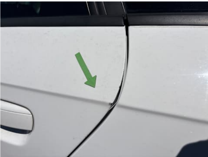
Türe hinten links (Lackschaden)
