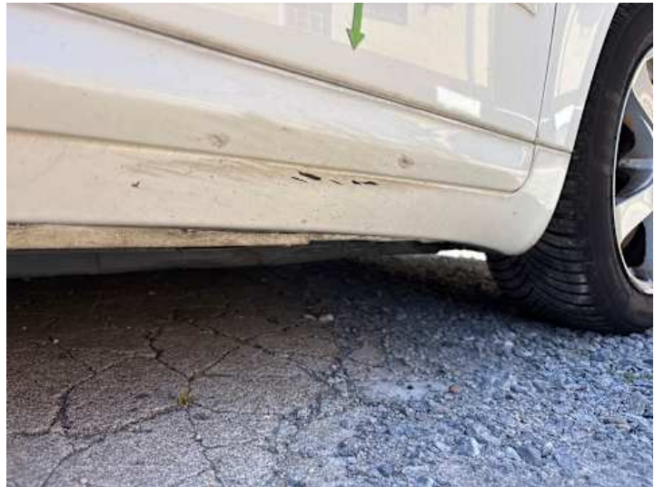
Schweller rechts (Kratzer, Lackschaden)
