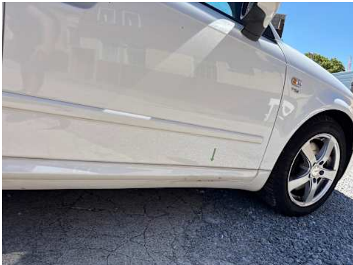
Schweller rechts (Kratzer, Lackschaden)
