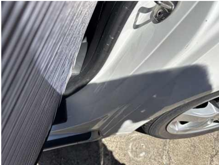
Schweller links (Kratzer, Delle)
