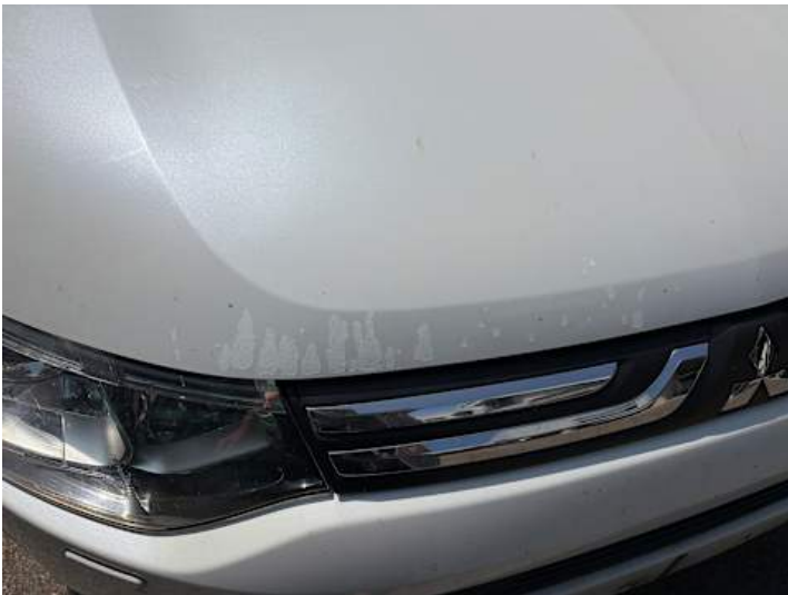
Motorhaube (Unsachgemäß instand gesetzt, Rost)
