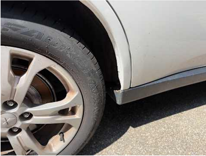
Schweller rechts (Rost)
