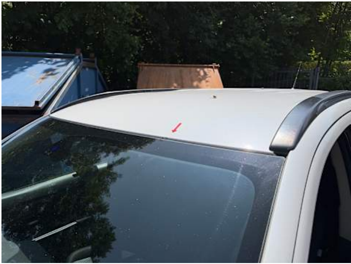
Dach (Steinschlag, Rost)
