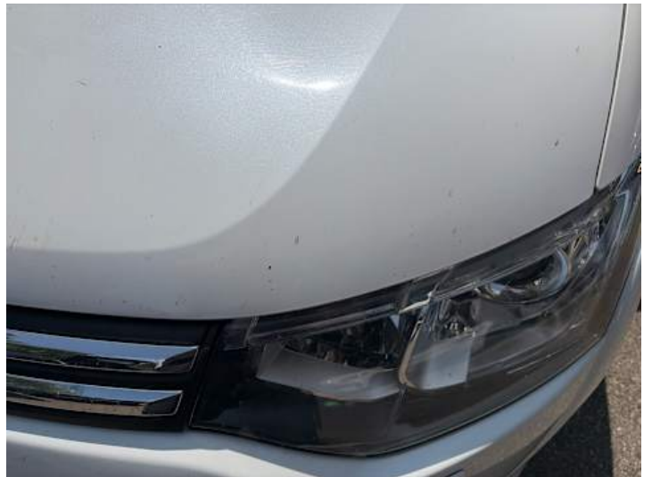
Motorhaube (Unsachgemäß instand gesetzt, Rost)
