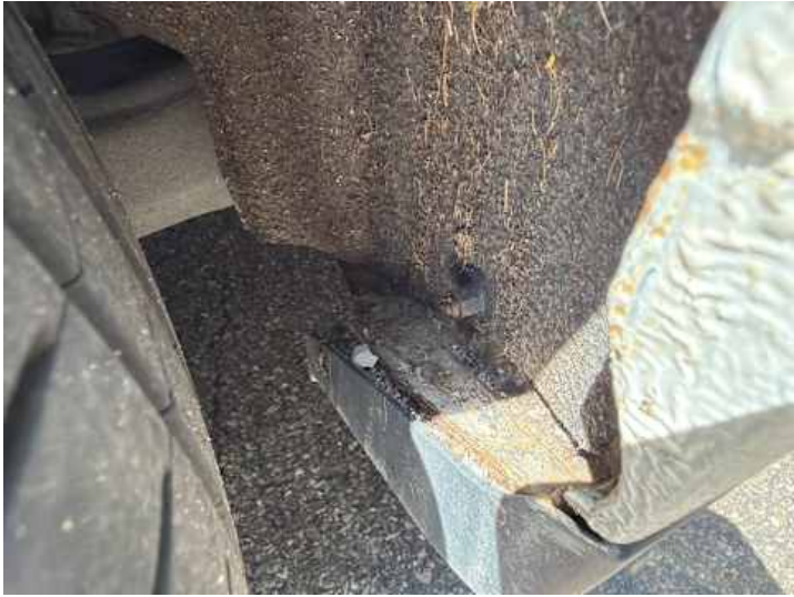
Schweller rechts (Rost)
