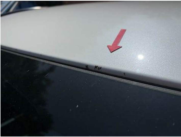
Dach (Steinschlag, Rost)
