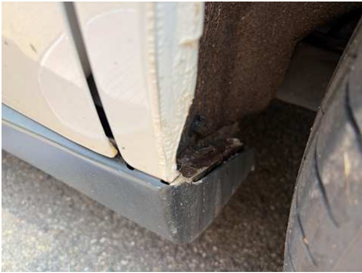
Schweller links (Rost)
