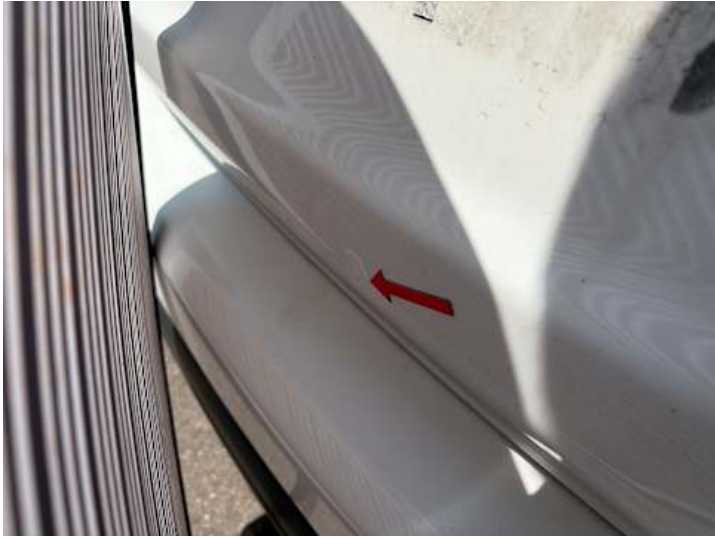
Heckklappe (Delle, Kratzer, Lackschaden)
