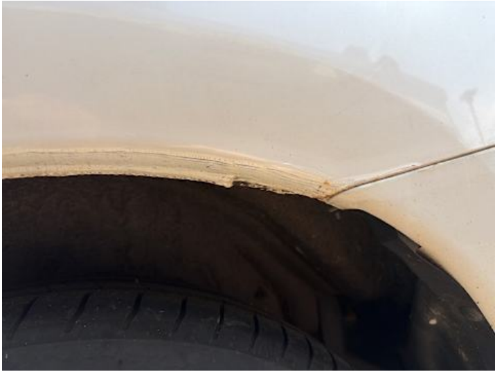
Seitenteil hinten links (Delle, Rost, Kratzer)
