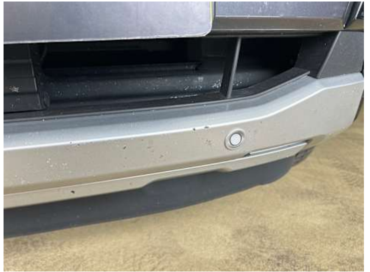
Stoßstange vorne (Kratzer, Lackschaden)
