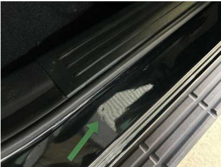
Schweller rechts (Delle, Kratzer)
