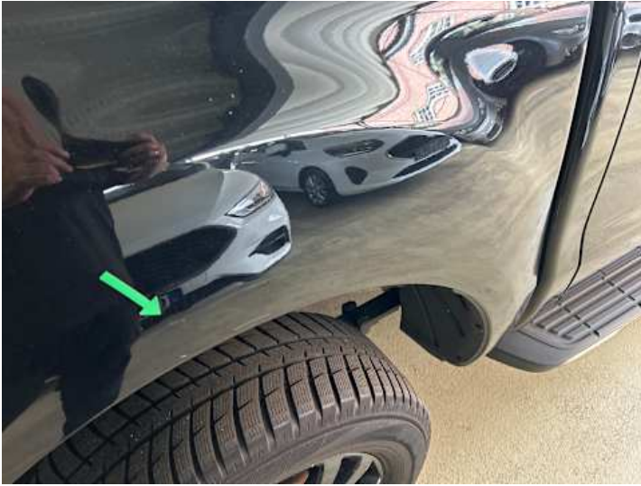
Seitenteil hinten rechts (Kratzer)
