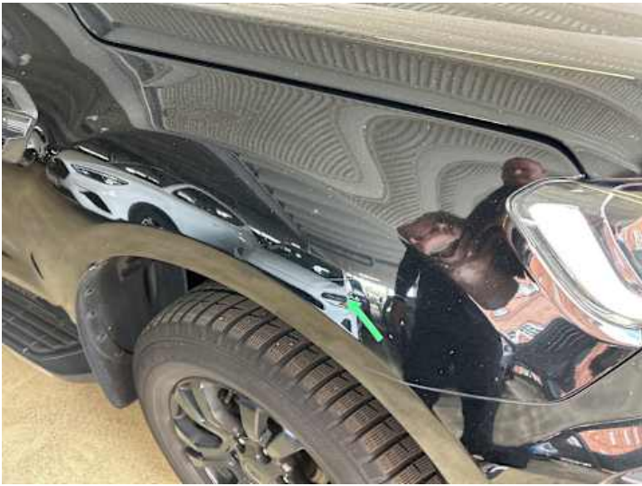
Kotflügel vorne rechts (Kratzer)
