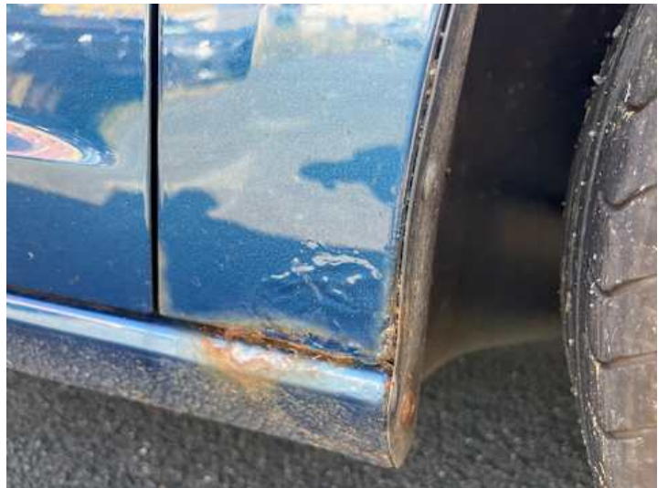
Kotflügel vorne rechts (Rost)
