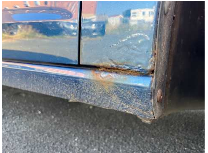
Schweller rechts (Rost)
