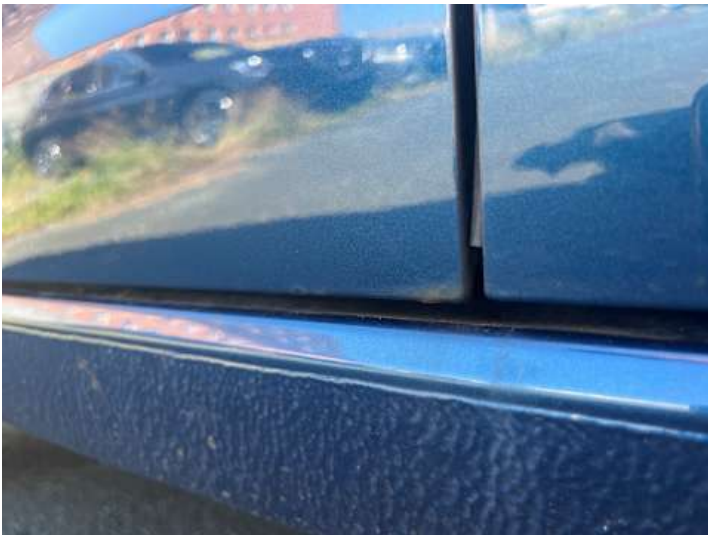
Türe hinten rechts (Rost)
