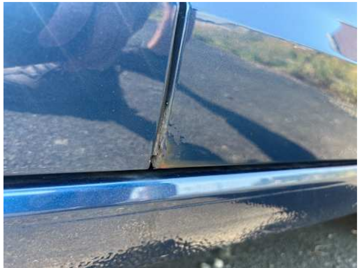
Türe hinten links (Rost)
