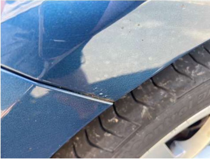
Seitenteil hinten rechts (Rost)
