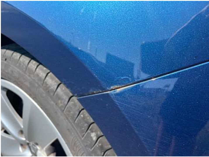
Seitenteil hinten links (Rost)
