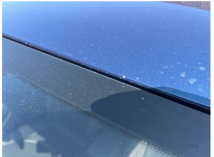
Dach (Steinschlag, Rost)
