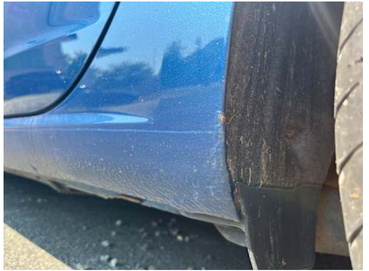
Schweller links (Rost)
