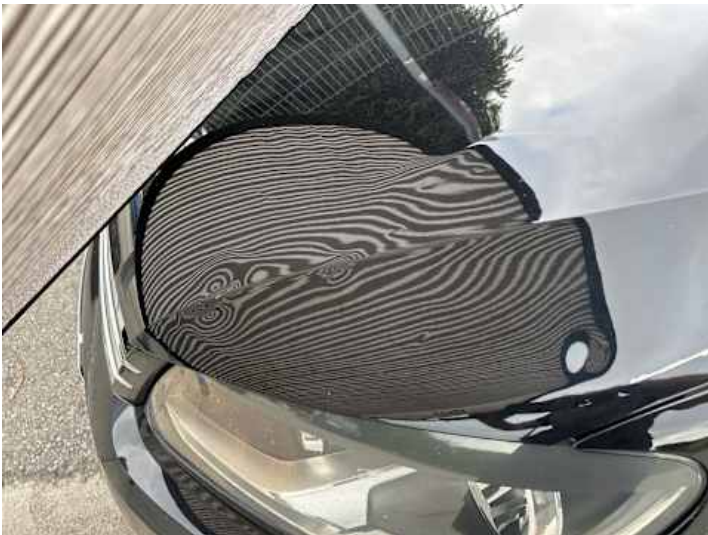
Motorhaube (Verformung, Lackschaden)
