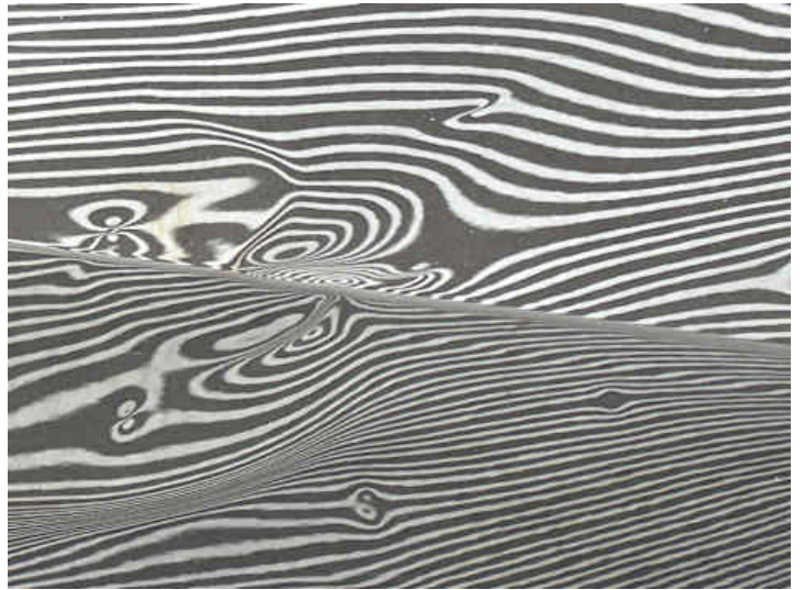
Motorhaube (Verformung, Lackschaden)
