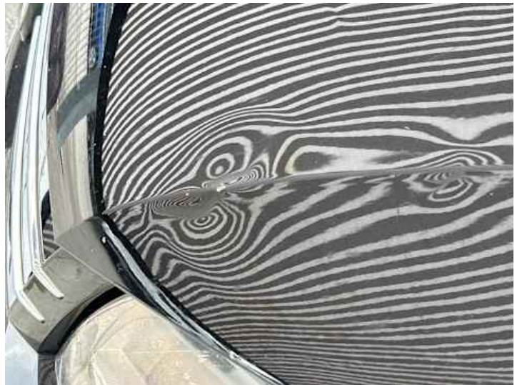
Motorhaube (Verformung, Lackschaden)
