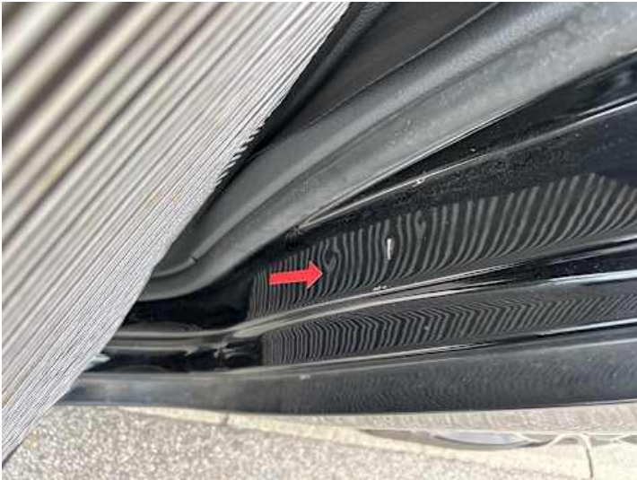
Schweller links (Kratzer, Delle)
