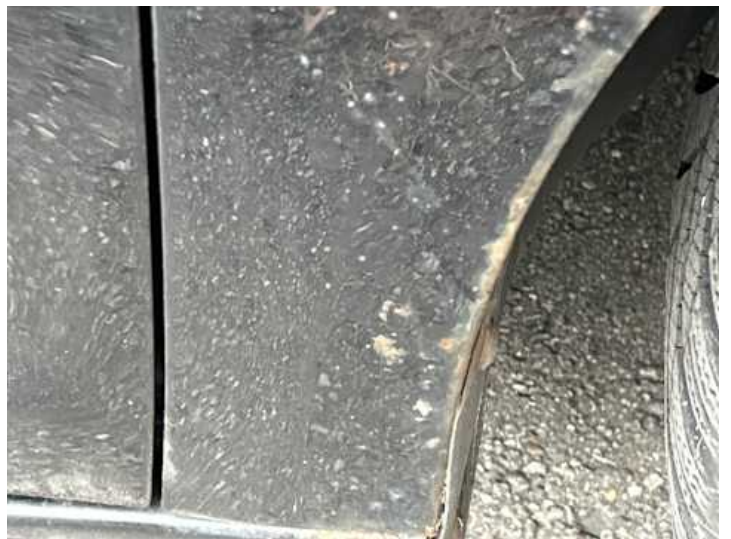
Kotflügel vorne rechts (Rost)
