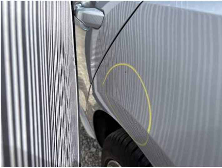
Seitenteil hinten links (Delle)
