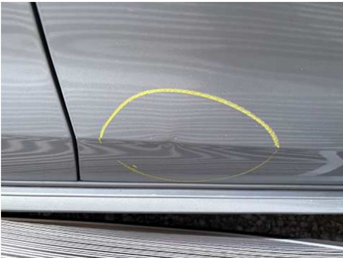
Beifahrtür (Kratzer, Delle)
