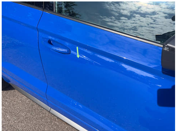
Beifahrertür (Lackschaden, Kratzer)
