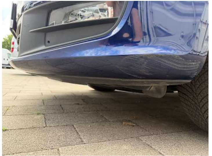
Stoßstange vorne (Kratzer, Lackschaden)
