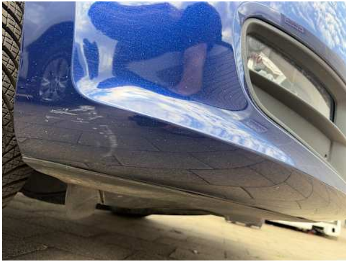
Stoßstange vorne (Kratzer, Lackschaden)
