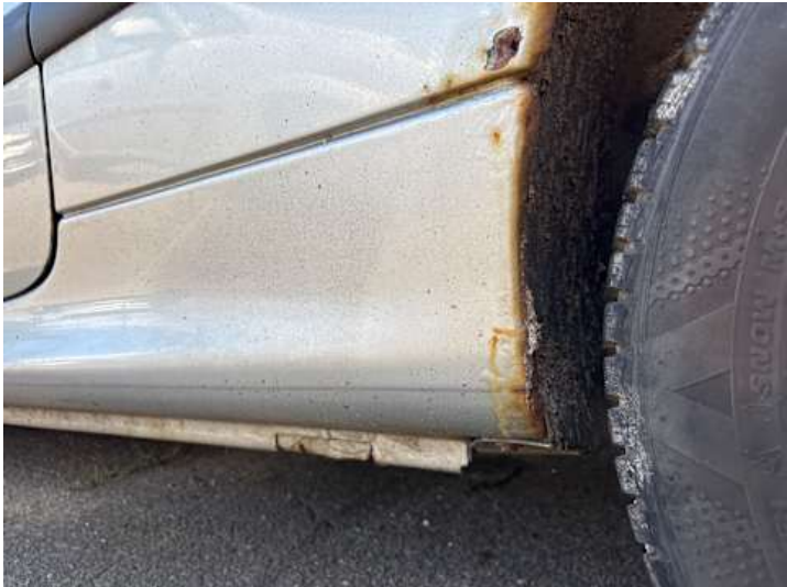
Schweller links (Rost)
