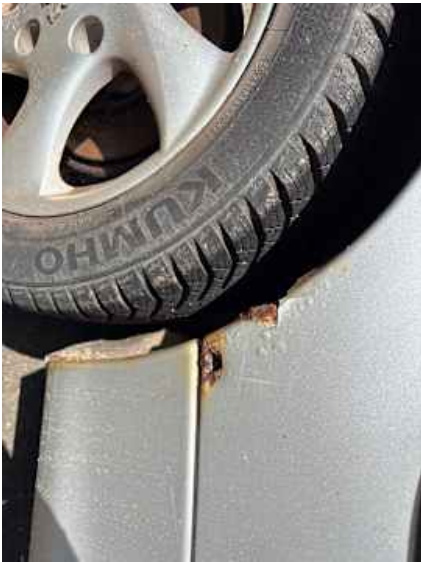
Seitenteil hinten rechts (Rost, Riss/Bruch)
