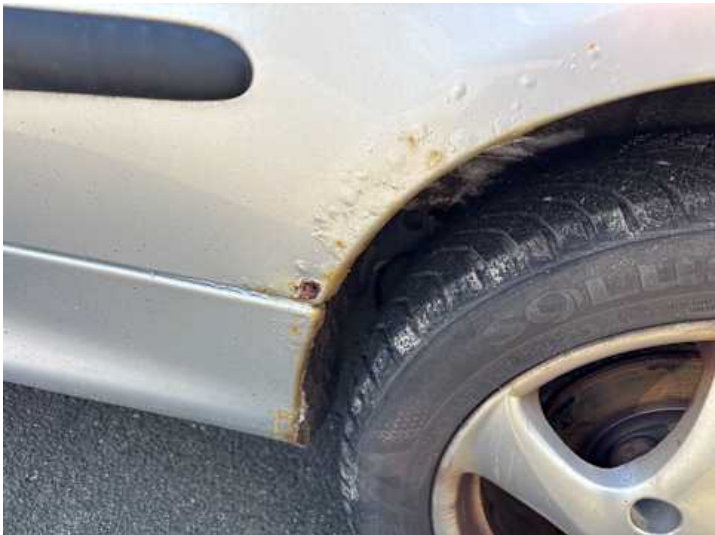
Seitenteil hinten links (Riss/Bruch, Rost)
