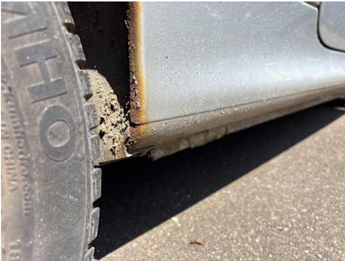
Schweller rechts (Rost)
