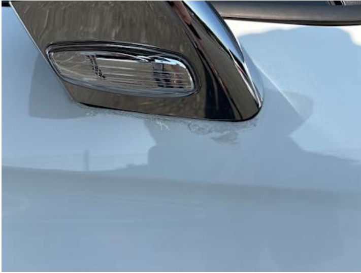
Beifahrertür (Lackschaden, Unsachgemäß instand gesetzt)
