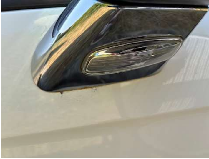
Fahrertür (Rost, Lackschaden, Unsachgemäß instand gesetzt)
