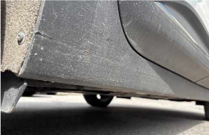
Schweller rechts (Kratzer)
