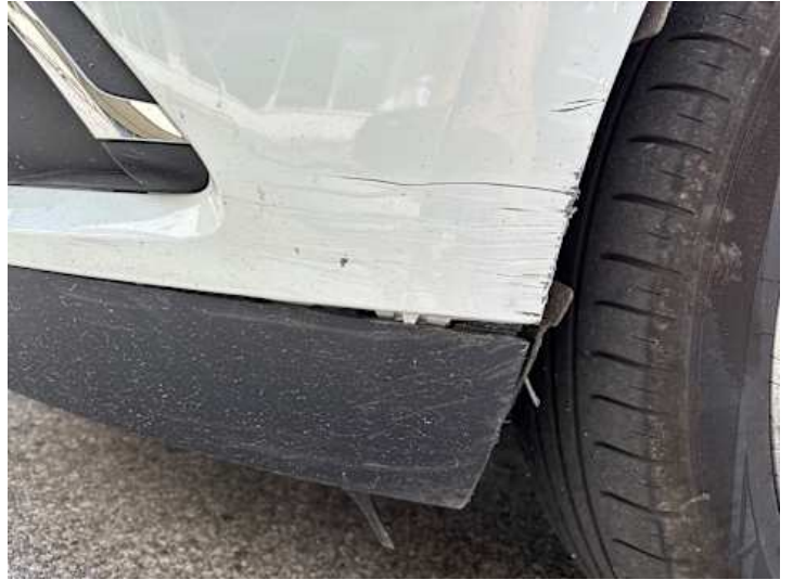
Stoßstange vorne (Kratzer, Riss/Bruch, Spaltmaße ungenau)
