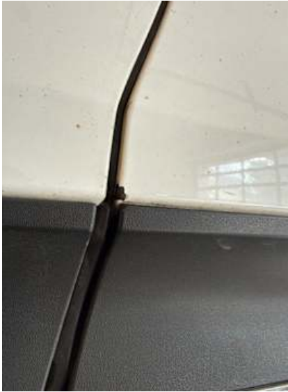
Türe hinten links (Rost)
