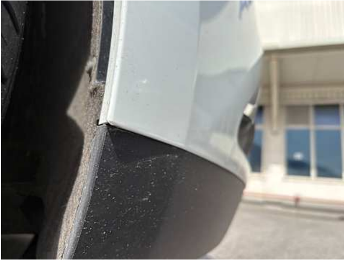
Stoßstange vorne (Spaltmaße ungenau)
