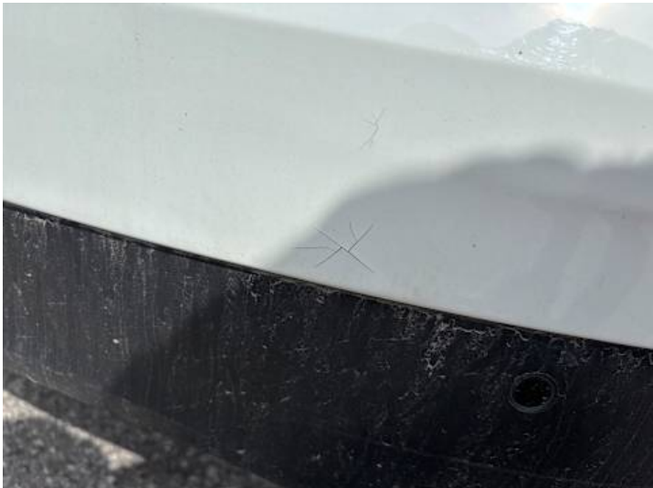
Stoßstange hinten (Riss/Bruch)
