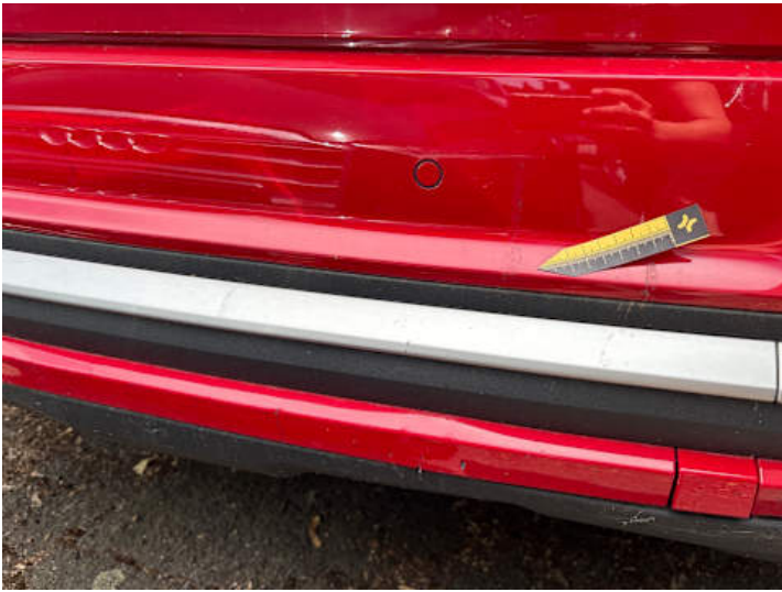
Stoßstange hinten (Verformung, Lackschaden)
