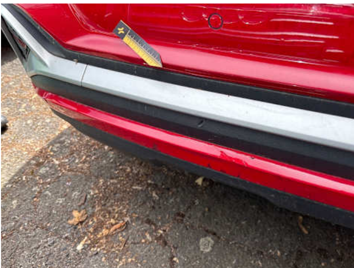
Stoßstange hinten (Verformung, Lackschaden)
