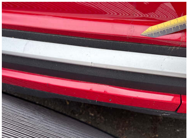
Stoßstange hinten (Verformung, Lackschaden)
