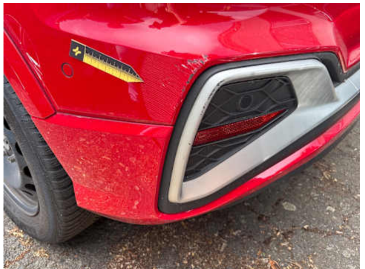
Stoßstange hinten (Verformung, Lackschaden)
