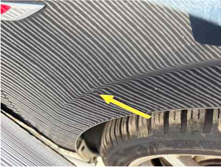
Kotflügel vorne rechts (Delle)
