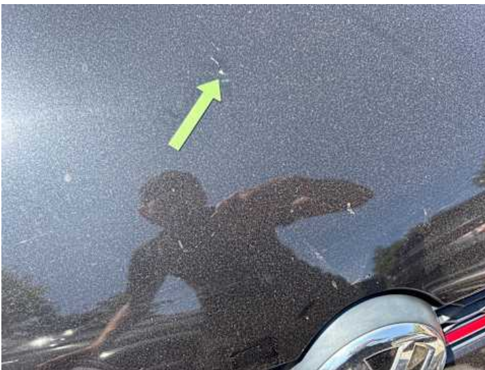
Motorhaube (Lackschaden, Steinschlag)
