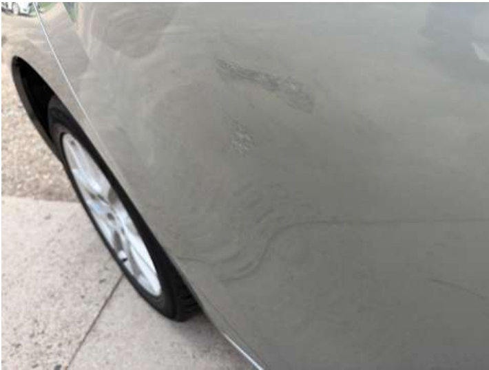
Türe hinten rechts (Lackschaden)
