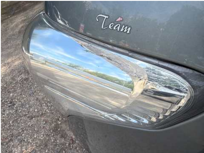
Rücklicht (rechts) (Riss/Bruch)
