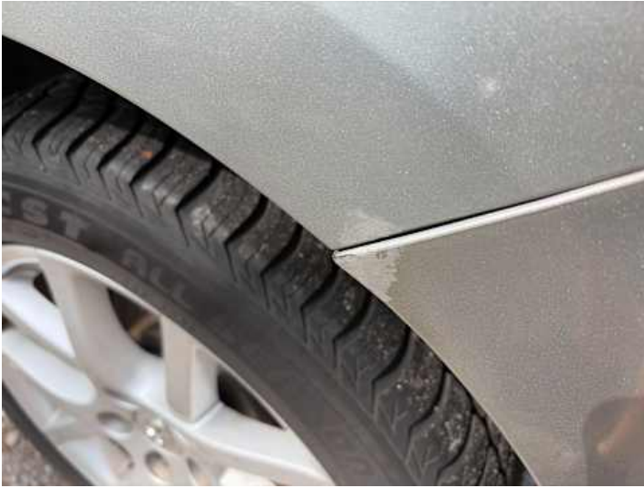
Seitenteil hinten links (Lackschaden)
