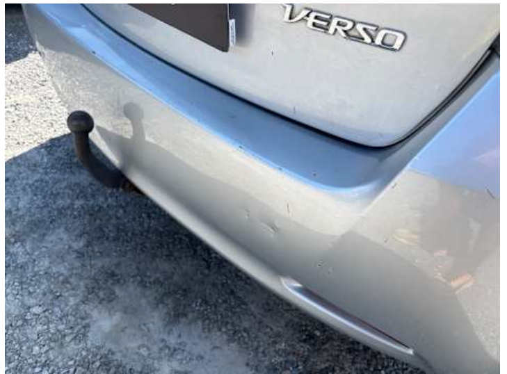
Stoßstange hinten (Kratzer, Verformung)
