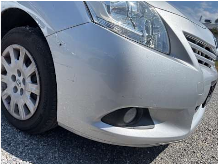
Stoßstange vorne (Riss/Bruch, Kratzer)
