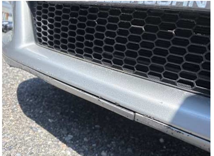
Stoßstange vorne (Riss/Bruch, Kratzer)
