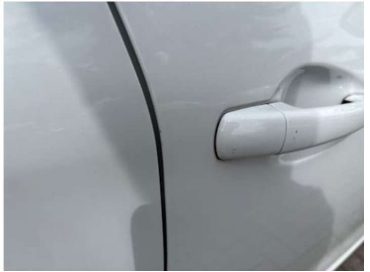
Beifahrertür (Lackschaden, Kratzer)
