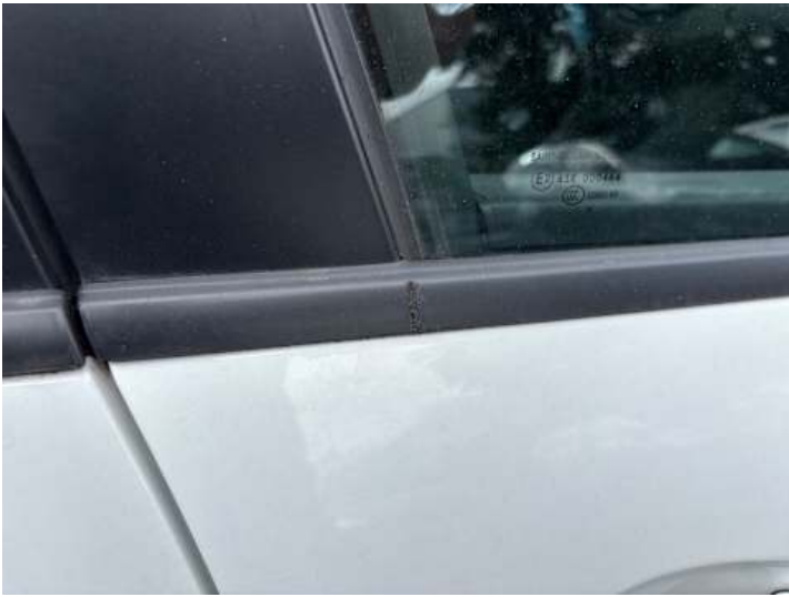
Beifahrertür (Lackschaden, Kratzer)
