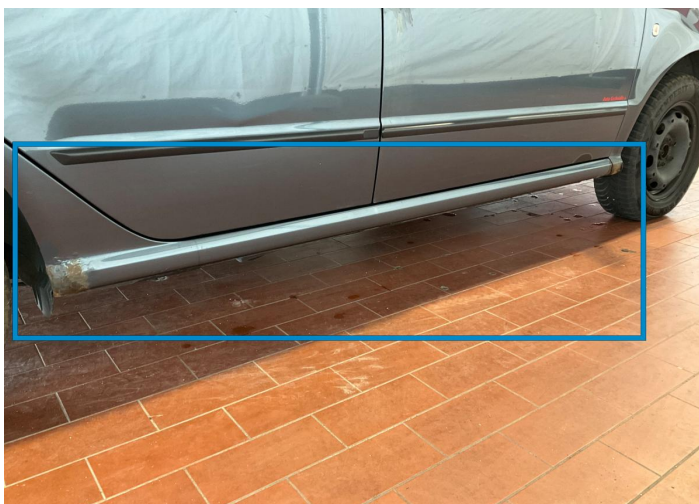
5. Einstiegsblech / MitteRechts Farbe / Kratzer / Zeile -
