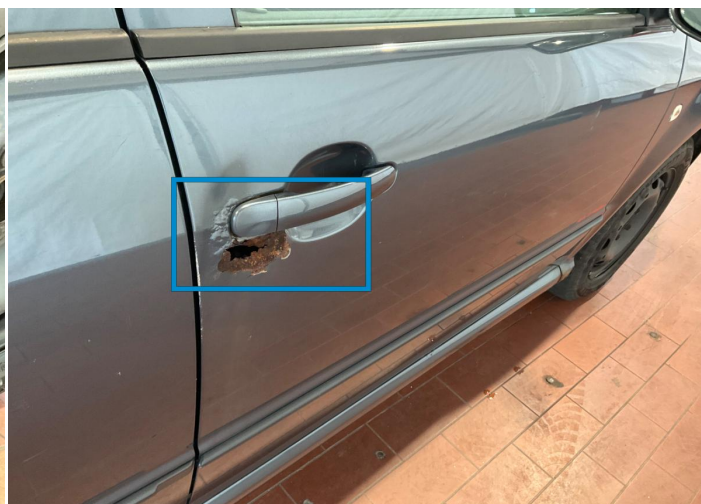
12. Tür / Vorne Rechts Lack / Rost -
