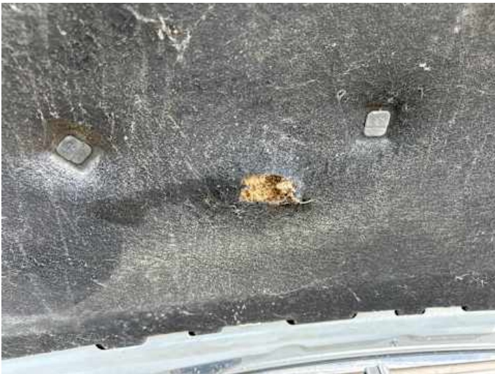
Motorhaube (Riss/Bruch, Lackschaden)
