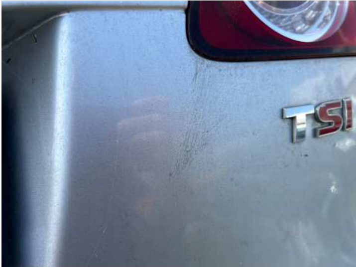
Heckklappe (Kratzer, Lackschaden)
