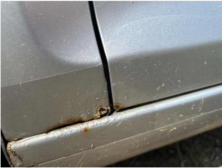
Fahrtür (Kratzer, Rost)
