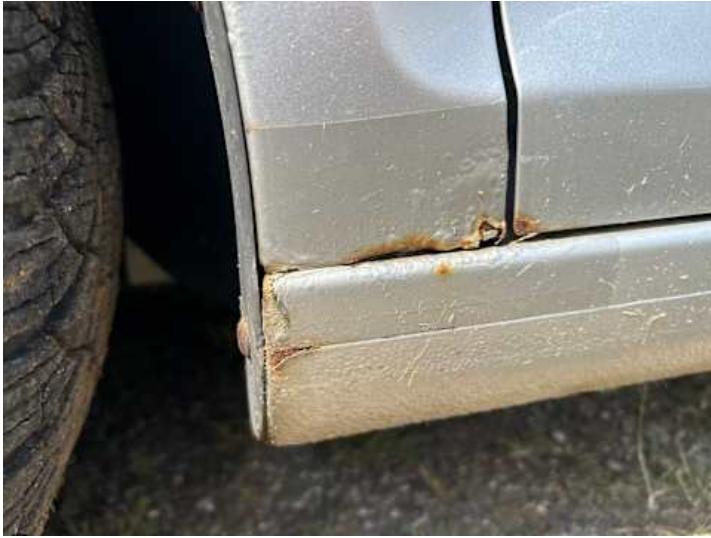
Schweller links (Rost)
