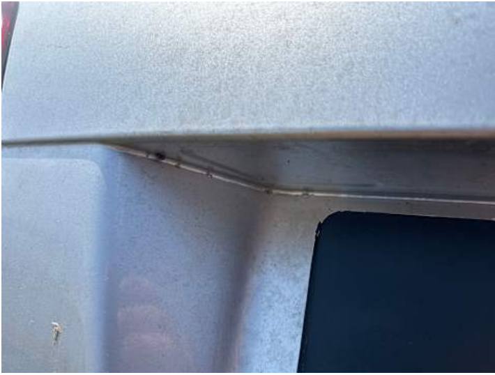
Heckklappe (Kratzer, Lackschaden)
