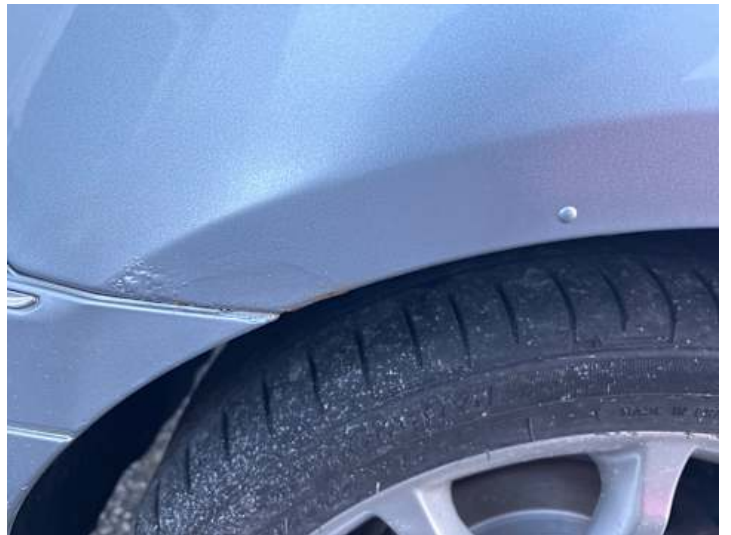
Seitenteil hinten rechts (Rost, Unsachgemäß instand gesetzt)
