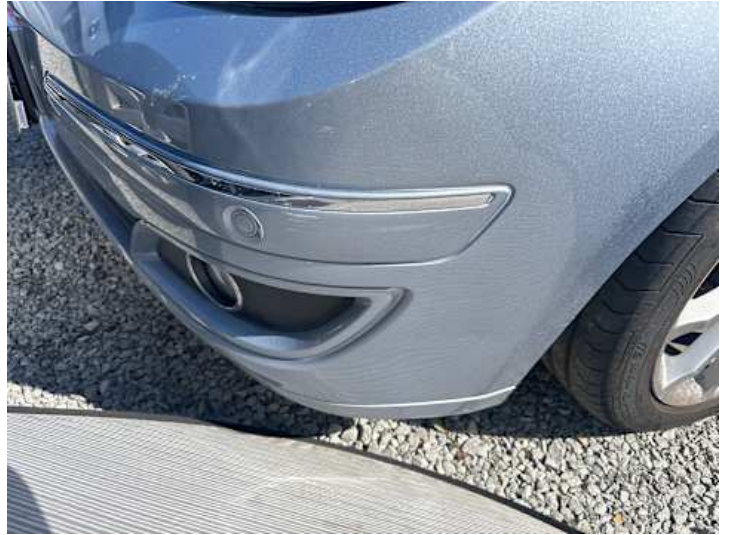
Stoßstange vorne (Verformung, Kratzer)
