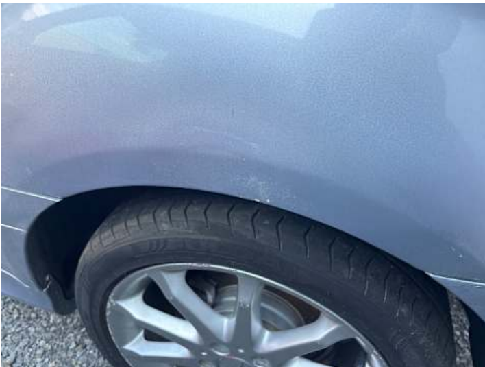
Seitenteil hinten links (Unsachgemäß instand gesetzt)
