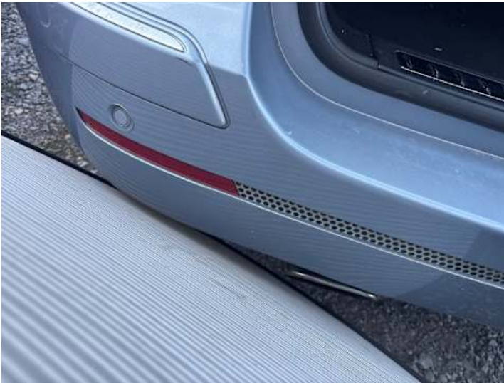
Stoßstange hinten (Verformung, Kratzer)
