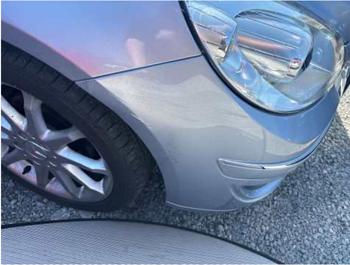
Stoßstange vorne (Verformung, Kratzer)
