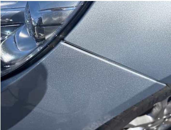
Stoßstange vorne (Lackschaden)
