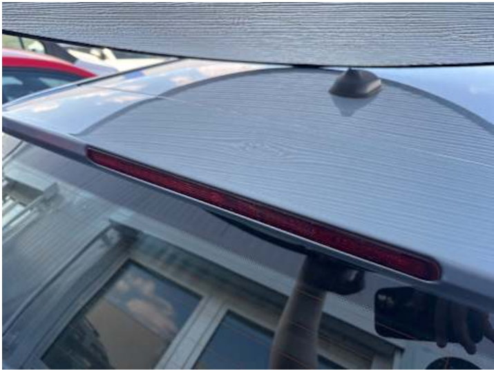
Heckklappe (Delle, Kratzer)
