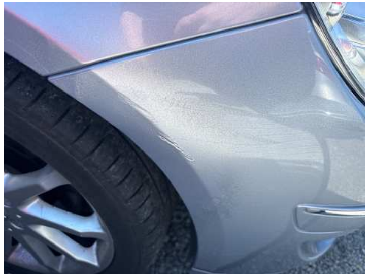
Stoßstange vorne (Unsachgemäß instand gesetzt)
