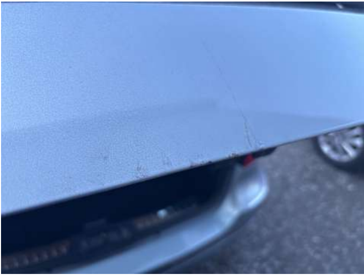
Heckklappe (Kratzer, Rost)
