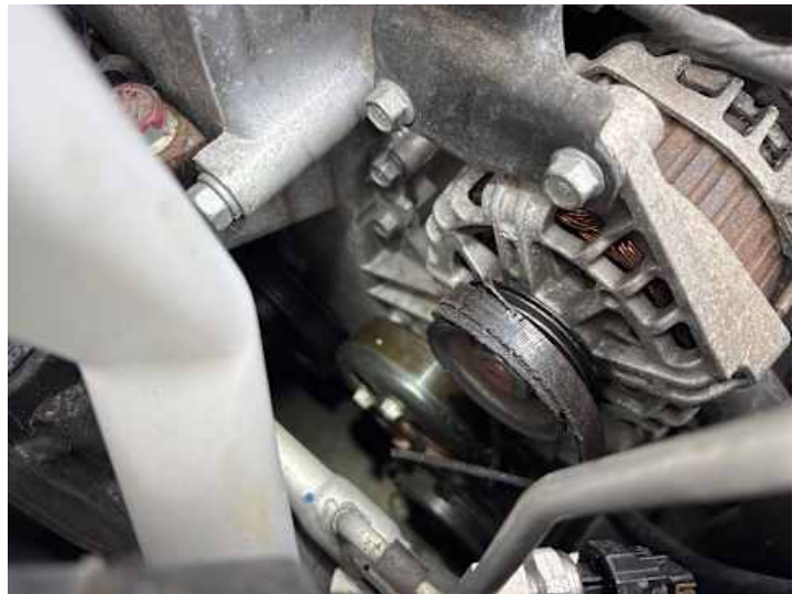
Motorhaube (Anderer Schaden): Keilriemen gerissen
