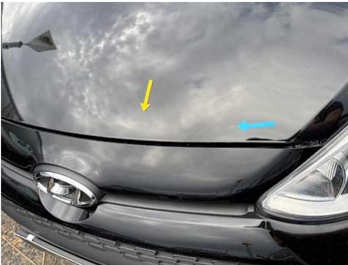
Motorhaube (Unsachgemäß instand gesetzt)
