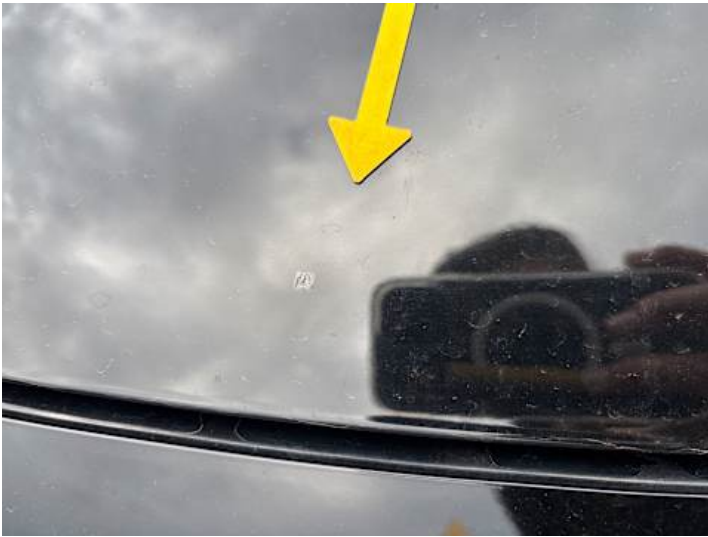
Motorhaube (Unsachgemäß instand gesetzt)
