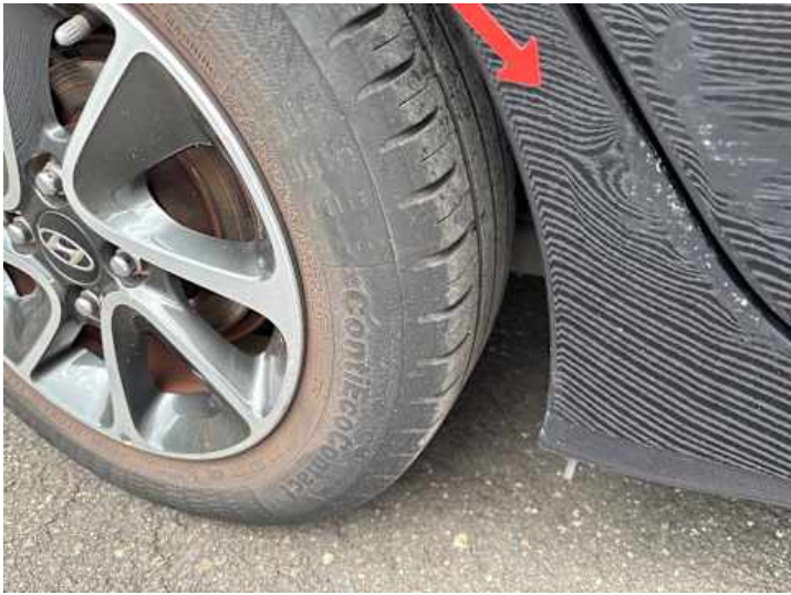
Seitenteil hinten rechts (Lackschaden, Delle)
