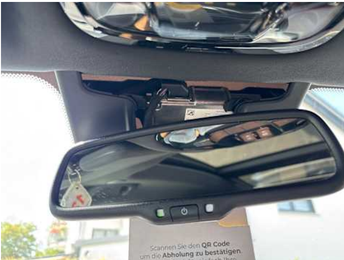
Innenraum (Anderer Schaden): Abdeckung fehlt
