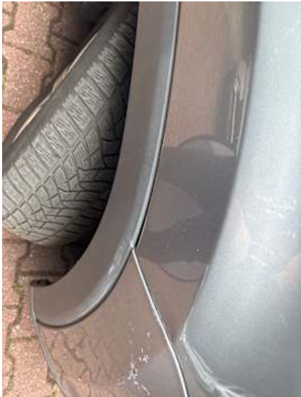
Kotflügel vorne rechts (Spaltmaße ungenau)
