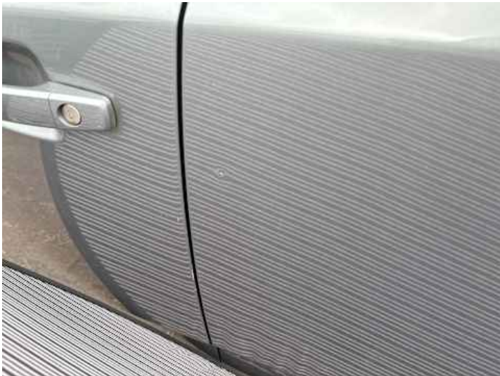
Türe hinten links (Delle)
