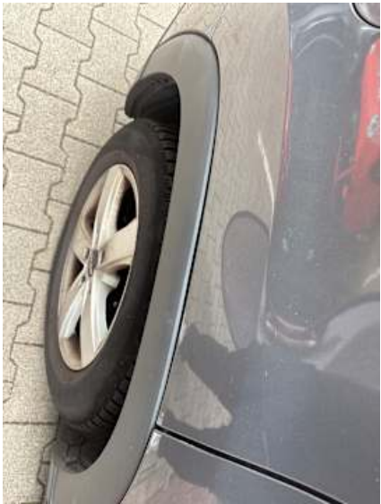
Seitenteil hinten rechts (Spaltmaße ungenau)
