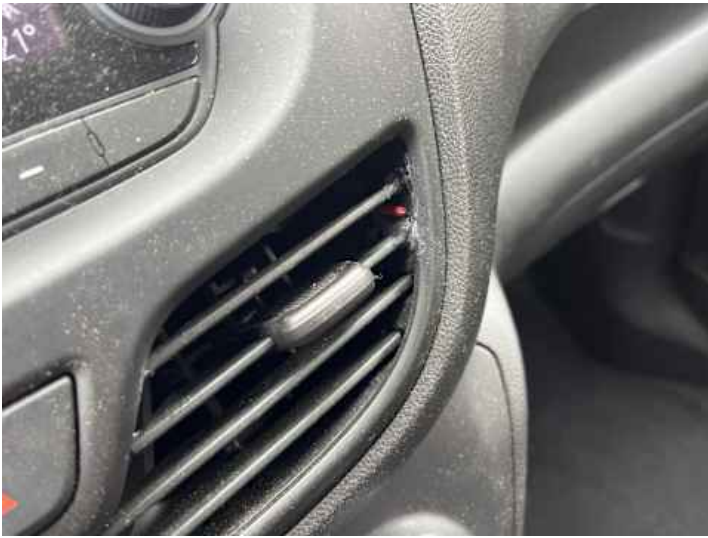
Innenraum (Verschleiß, Kratzer, Verschmutzung, Riss/Bruch)
