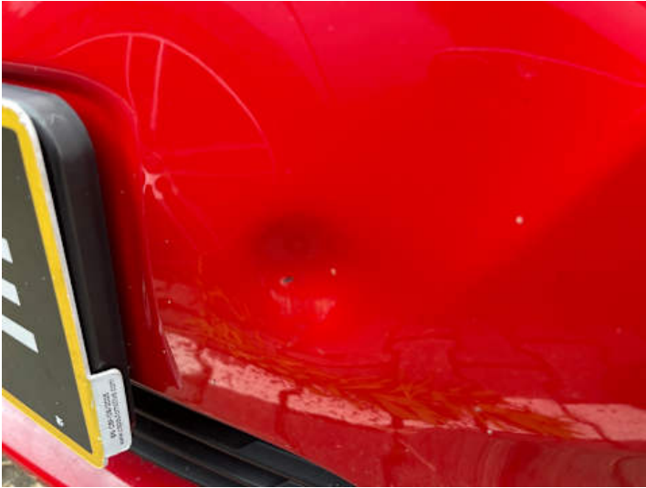
Stoßstange vorne (Delle)
