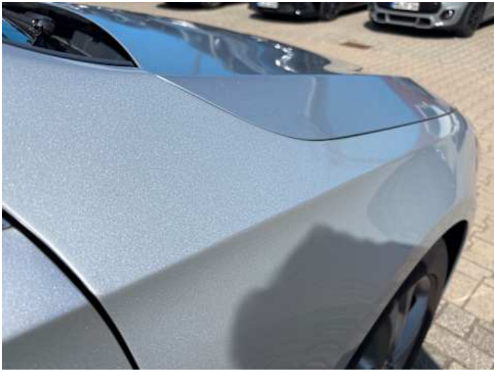
Kotflügel vorne rechts (Unsachgemäß instand gesetzt, Anderer Schaden): Farbunterschied
