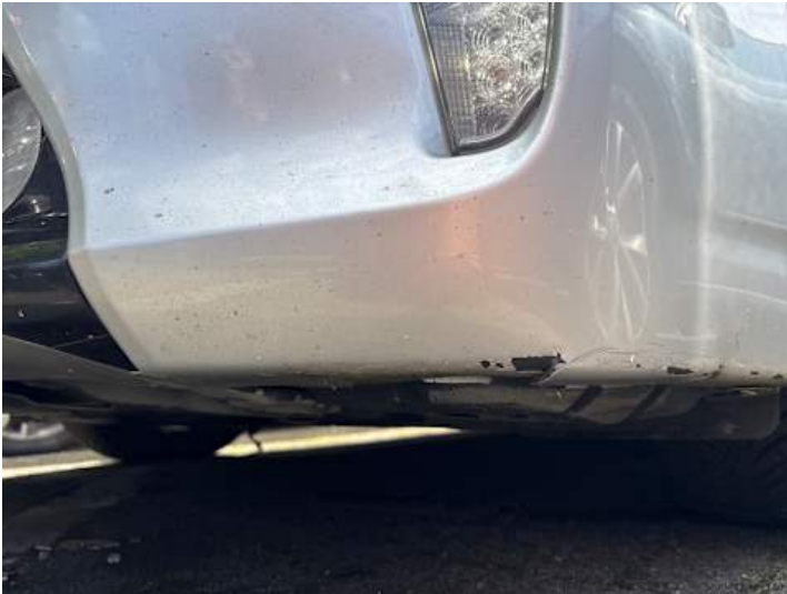
Stoßstange vorne (Riss/Bruch, Kratzer)
