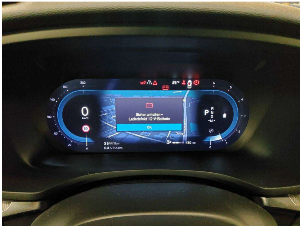
Bild 7 : Ladedefekt 12V Batterie, erneuern
