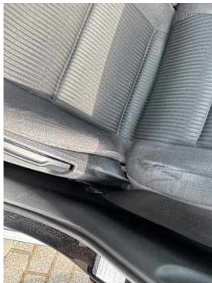
Innenraum (Diverse Schäden, Riss/Bruch)
