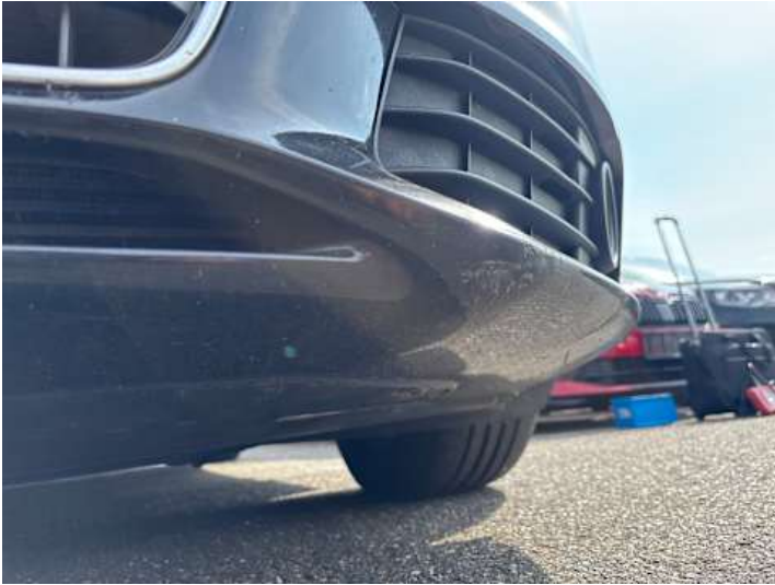
Stoßstange vorne (Kratzer, Riss/Bruch)
