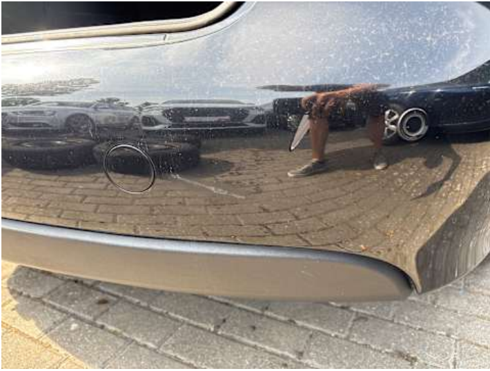
Stoßstange hinten (Kratzer)
