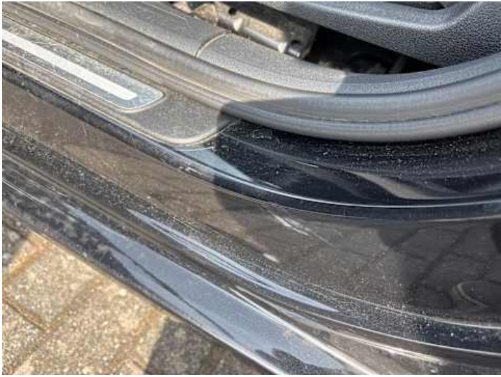
Schweller links (Kratzer)
