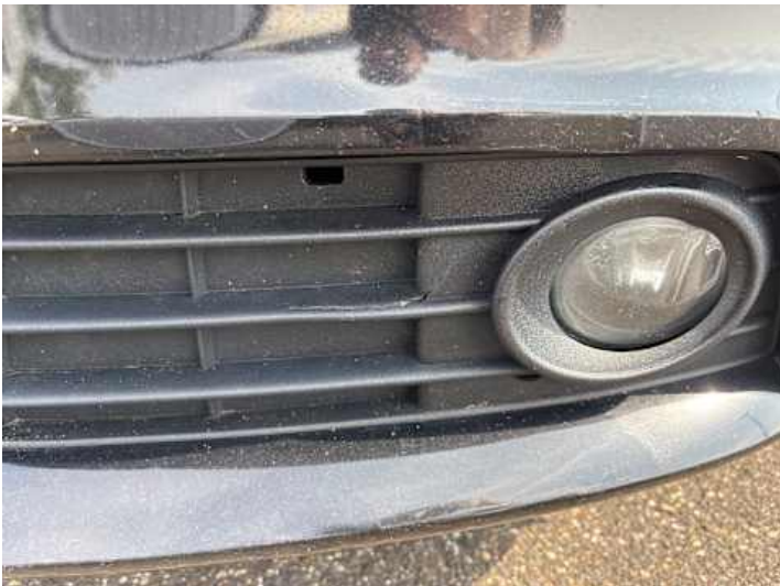
Stoßstange vorne (Kratzer, Riss/Bruch)
