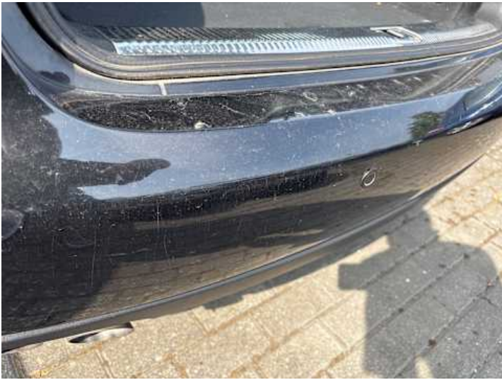
Stoßstange hinten (Kratzer)
