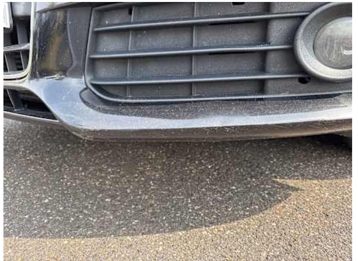
Stoßstange vorne (Kratzer, Riss/Bruch)
