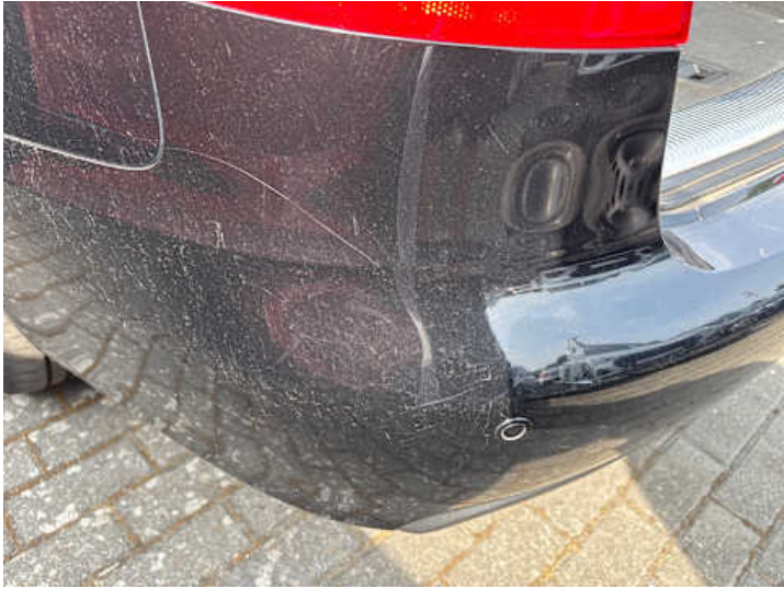
Stoßstange hinten (Kratzer)
