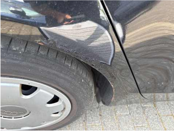
Seitenteil hinten rechts (Lackschaden, Kratzer, Rost, Delle)
