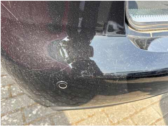
Stoßstange hinten (Kratzer)
