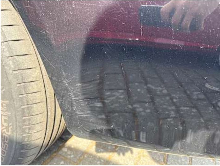
Stoßstange hinten (Kratzer)
