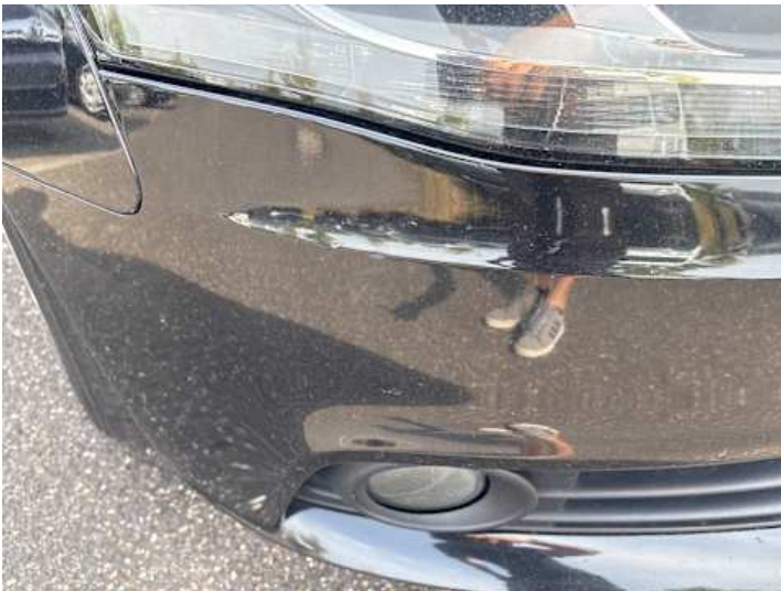
Stoßstange vorne (Kratzer, Riss/Bruch)
