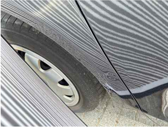
Seitenteil hinten rechts (Lackschaden, Kratzer, Rost, Delle)
