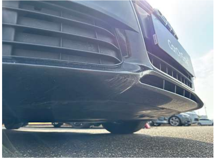
Stoßstange vorne (Kratzer, Riss/Bruch)
