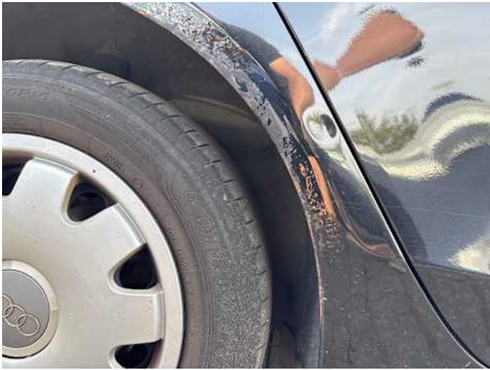
Seitenteil hinten rechts (Lackschaden, Kratzer, Rost, Delle)
