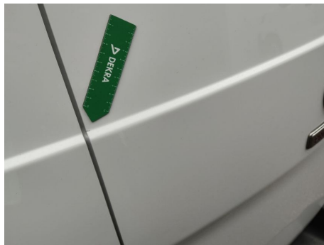
Tür / Hinten Rechts / Delle
