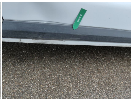
Türzierleiste / Vorne Rechts / Kratzer
