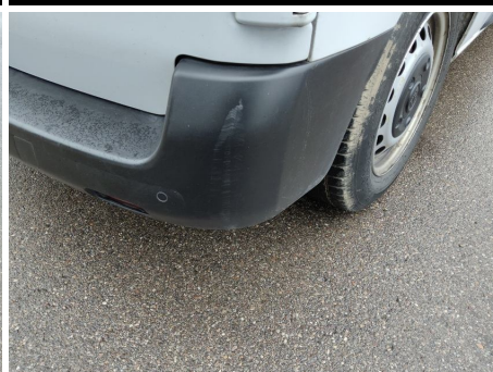
Stoßfänger / Hinten / Kratzer
