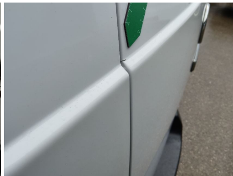
Tür / Hinten Rechts / Delle
