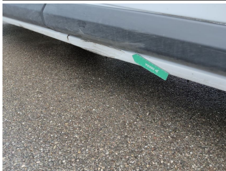
Schweller / Rechts / Delle
