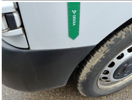
Seitenwand / Hinten Rechts / Kratzer
