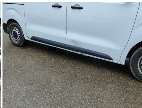
Schweller / Rechts / Delle
