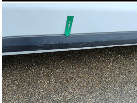
Türzierleiste / Rechts / Kratzer
