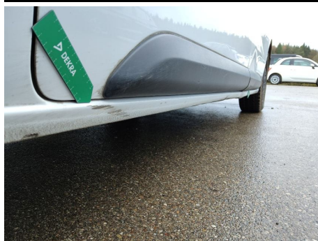
Schweller / Rechts / Delle
