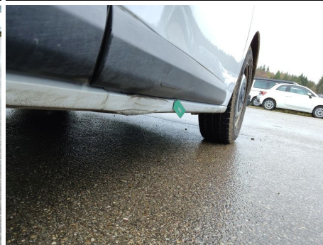
Schweller / Rechts / Delle
