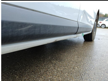
Schweller / Rechts / Delle
