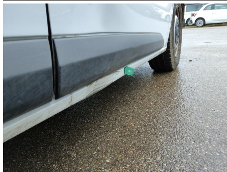
Schweller / Rechts / Delle
