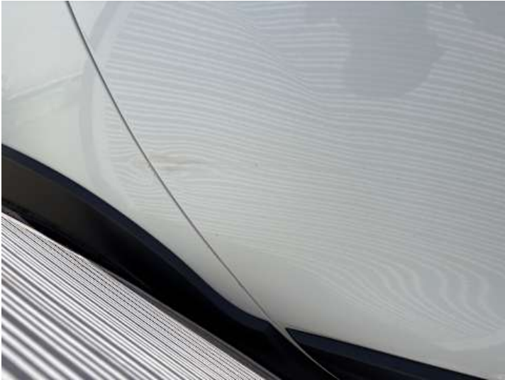
Türe hinten rechts (Delle, Kratzer)
