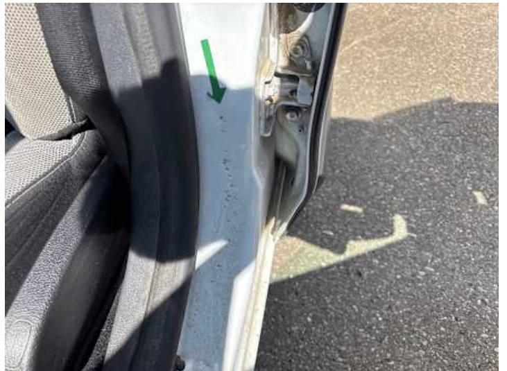
Fahrrertür (Kratzer, Steinschlag, Delle)
