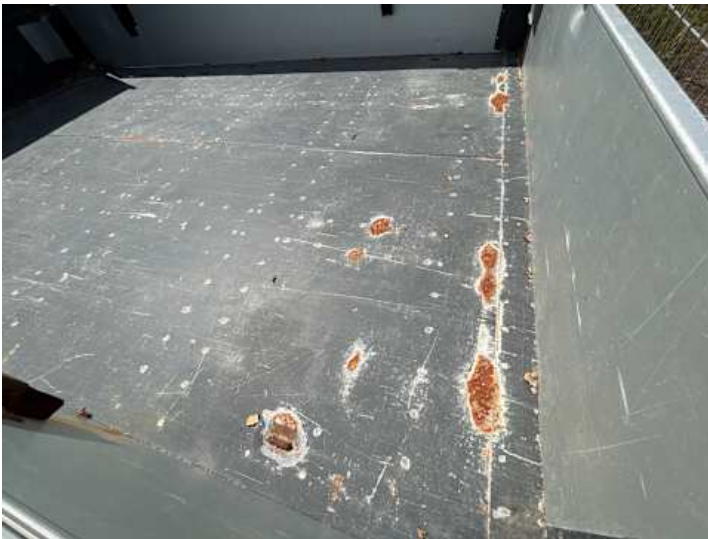
Innenraum (Anderer Schaden, Diverse Schäden): Korrosion
