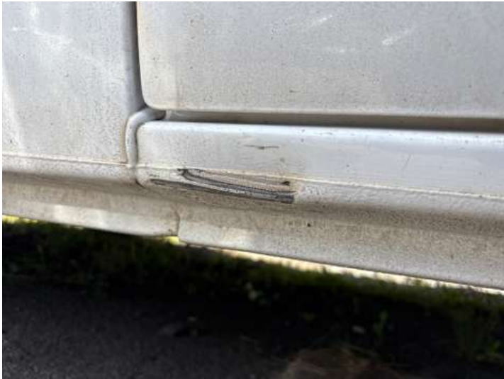
Schweller links (Verformung, Kratzer)
