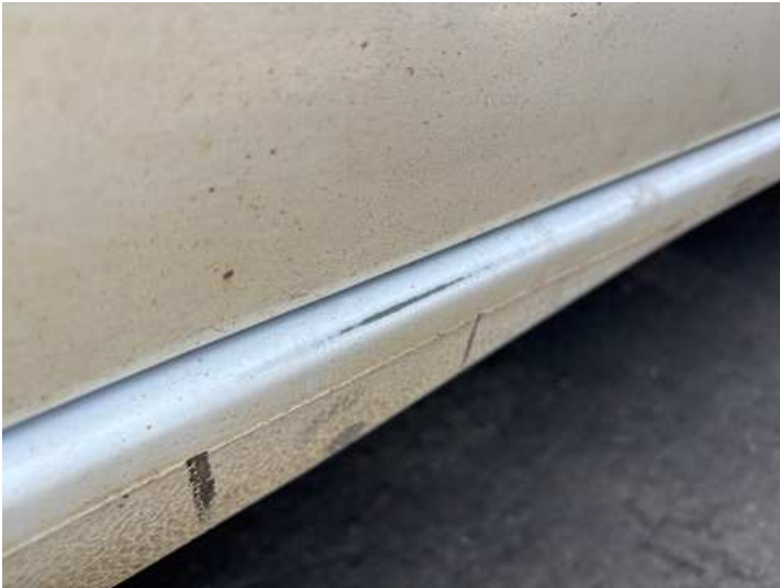
Schweller links (Verformung, Kratzer)
