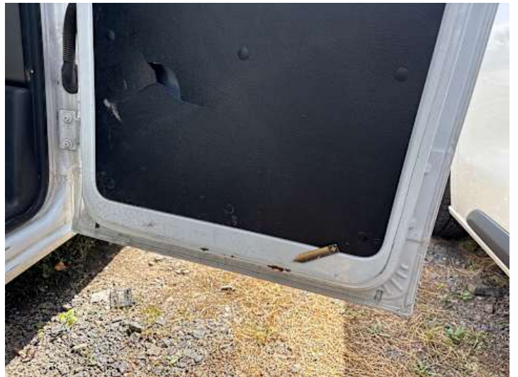
Türe hinten rechts (Lackschaden, Rost)
