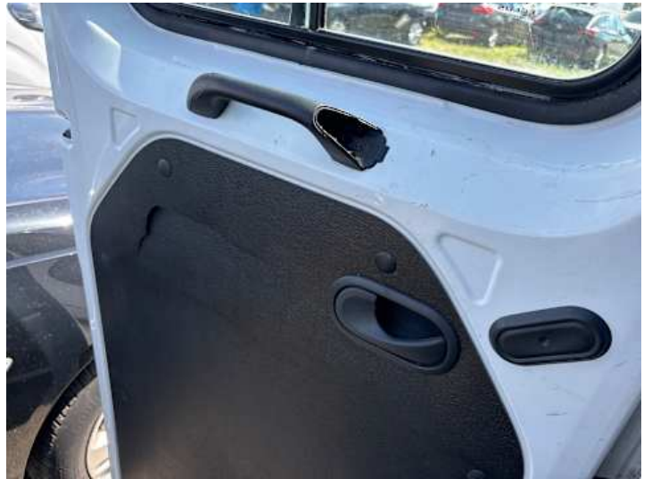
Innenraum (Diverse Schäden, Riss/Bruch)
