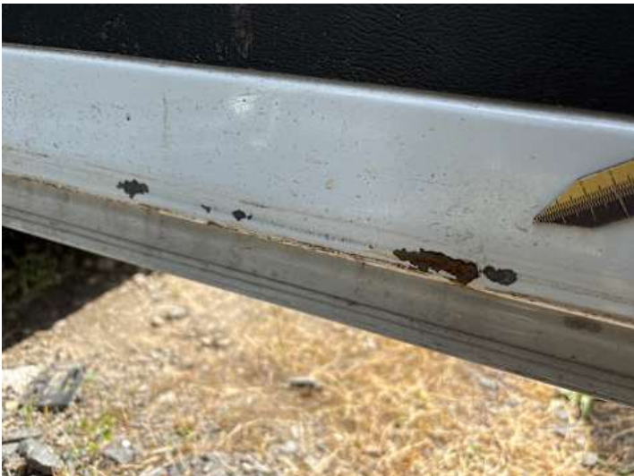
Türe hinten rechts (Lackschaden, Rost)
