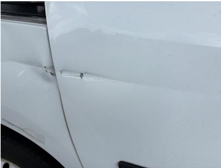
Türe hinten rechts (Anderer Schaden, Lackschaden, Delle): Unfall Schaden
