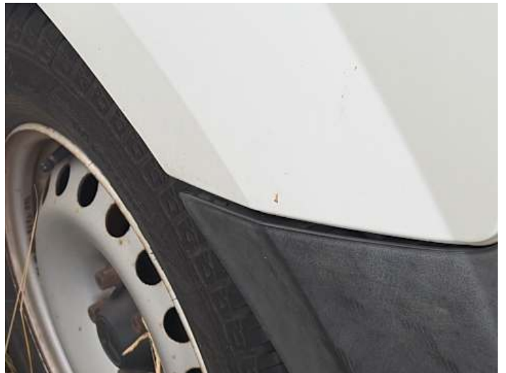
Stoßstange hinten (Spaltmaße ungenau)
