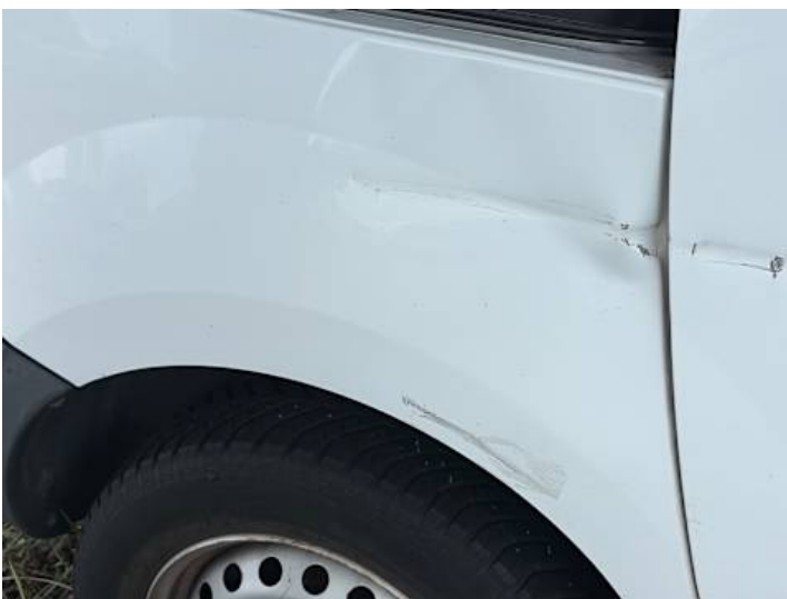
Seitenteil hinten rechts (Delle, Lackschaden, Anderer Schaden): Unfall Schaden
