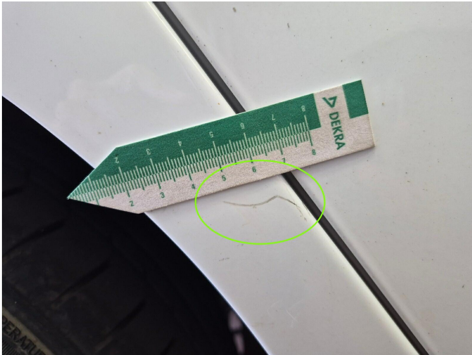
Bild 17 : Seitenwand rechts bis auf Grundierung zerkratzt
