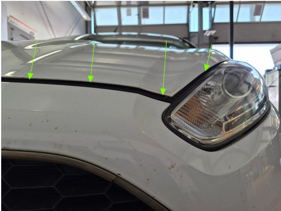
Bild 9 : Nicht reparierter Unfallschaden im Frontbereich, Schadenerweiterung nach Zerlegung möglich
