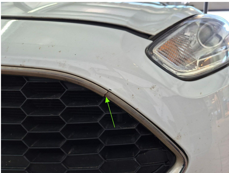
Bild 10 : Nicht reparierter Unfallschaden im Frontbereich, Schadenerweiterung nach Zerlegung möglich
