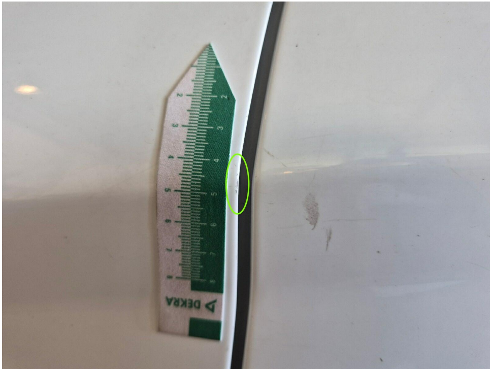
Bild 13 : Tür vorn links im hinteren Kantenbereich oberflächlich verschrammt
