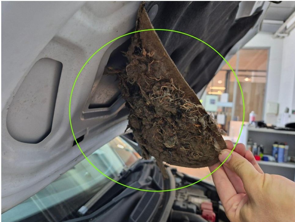
Bild 19 : Frontklappe Dämmmatte weist Tierbissähnliche Beschädigungen auf
