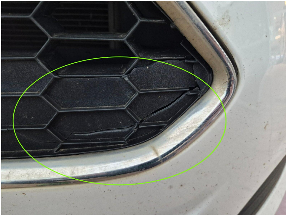
Bild 11 : Nicht reparierter Unfallschaden im Frontbereich, Schadenerweiterung nach Zerlegung möglich
