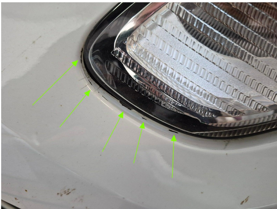
Bild 12 : Nicht reparierter Unfallschaden im Frontbereich, Schadenerweiterung nach Zerlegung möglich
