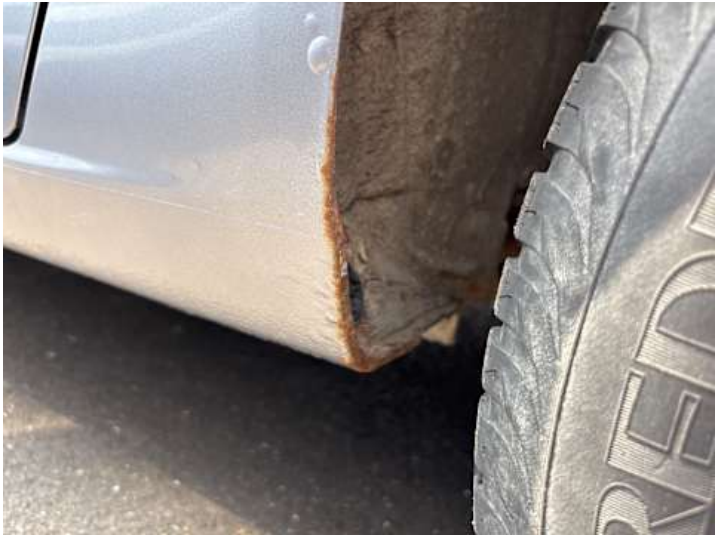
Schweller links (Rost)
