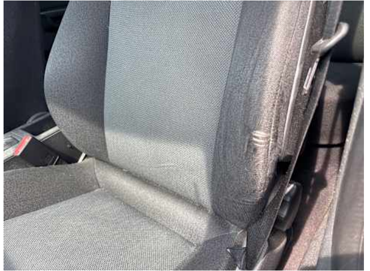
Innenraum (Verschleiß, Riss/Bruch)
