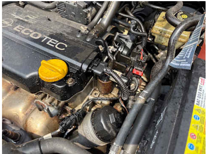
Motorhaube (Anderer Schaden): Ölverlust,
