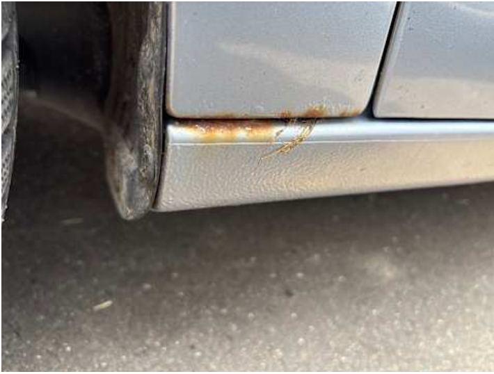
Schweller links (Rost)
