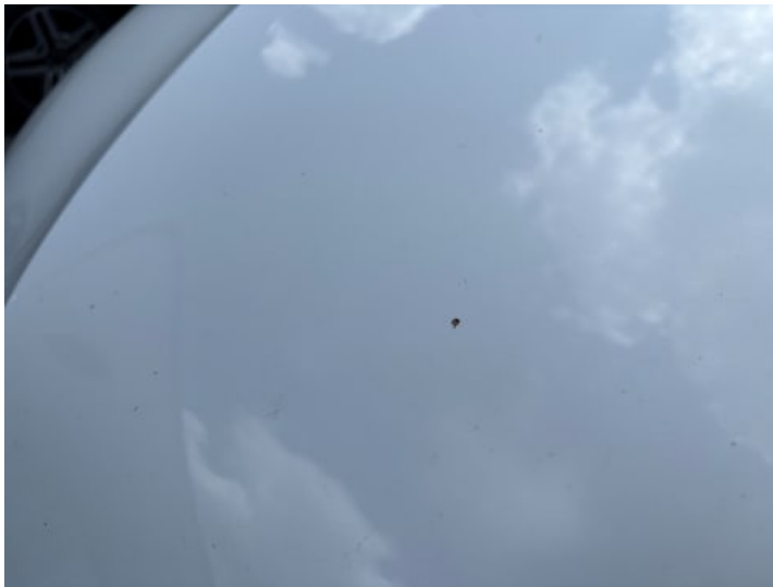
Motorhaube (Rost, Steinschlag)
