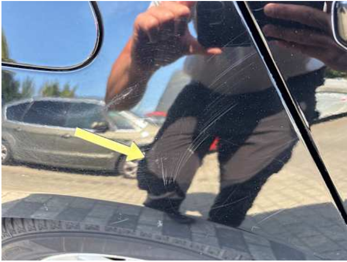
Seitenteil hinten rechts (Kratzer)
