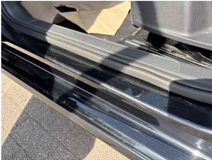
Schweller links (Kratzer, Delle)
