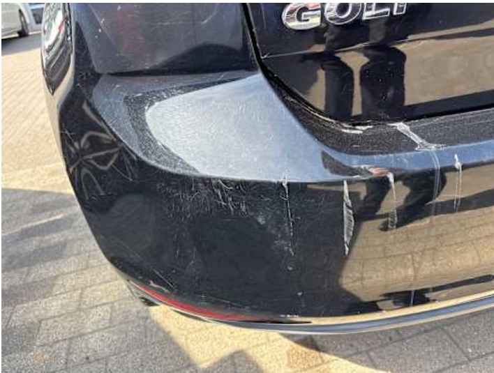
Stoßstange hinten (Kratzer)
