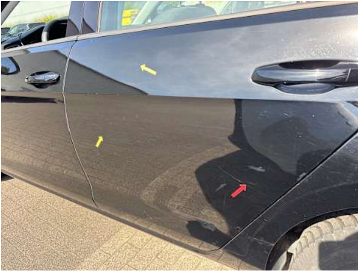
Türe hinten links (Kratzer)
