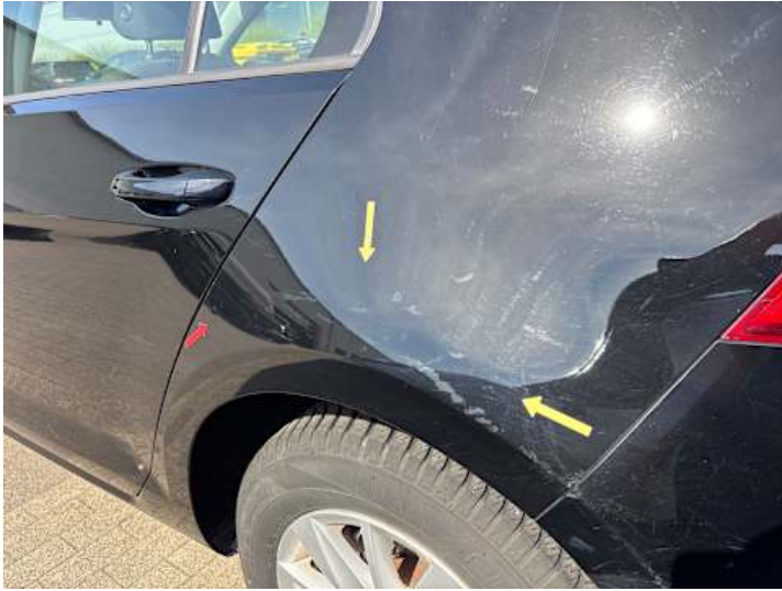
Seitenteil hinten links (Kratzer, Delle)
