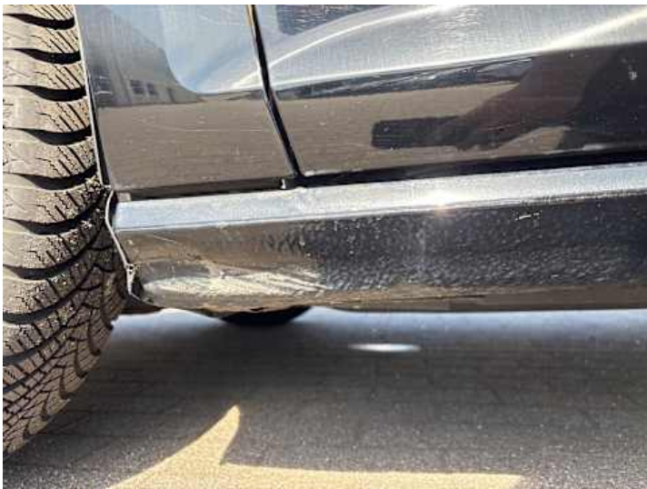
Schweller links (Verformung, Kratzer)
