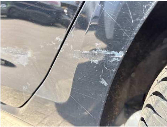
Seitenteil hinten links (Kratzer, Delle)
