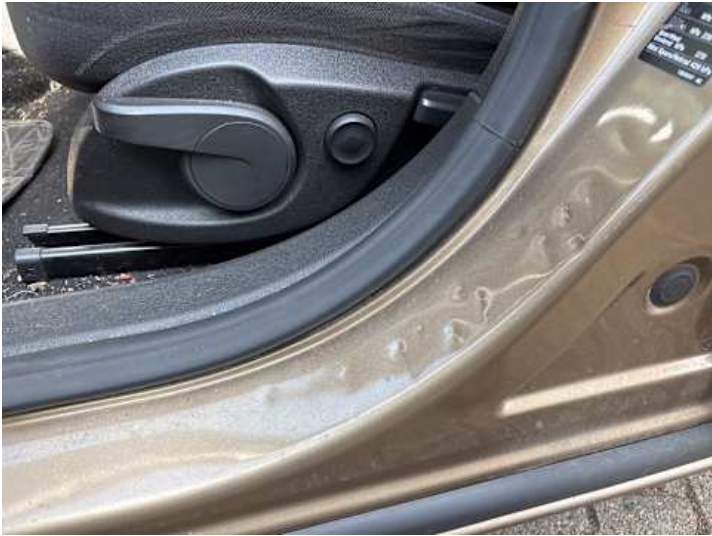
Schweller links (Kratzer, Delle)
