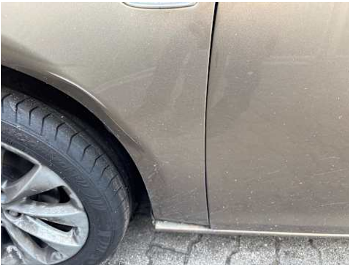
Fahrtür (Spaltmaße ungenau)
