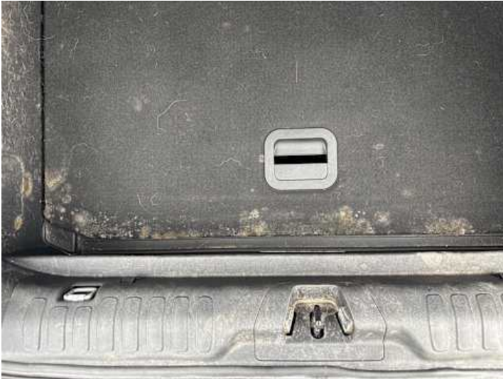
Innenraum (Tierhaare/Tiergeruch, Anderer Schaden): Schimmel
