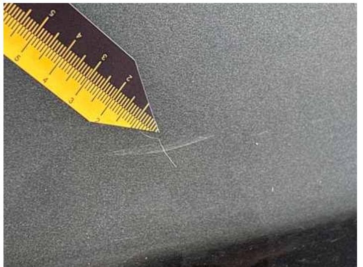
Türe hinten rechts (Kratzer)
