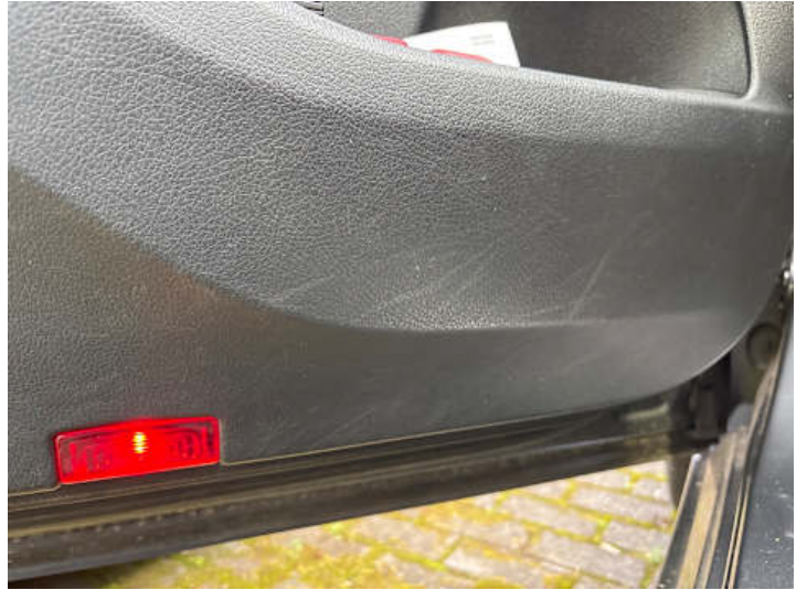
Innenraum (Verschleiß, Kratzer)
