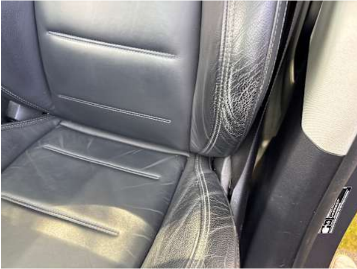
Innenraum (Verschleiß, Kratzer)
