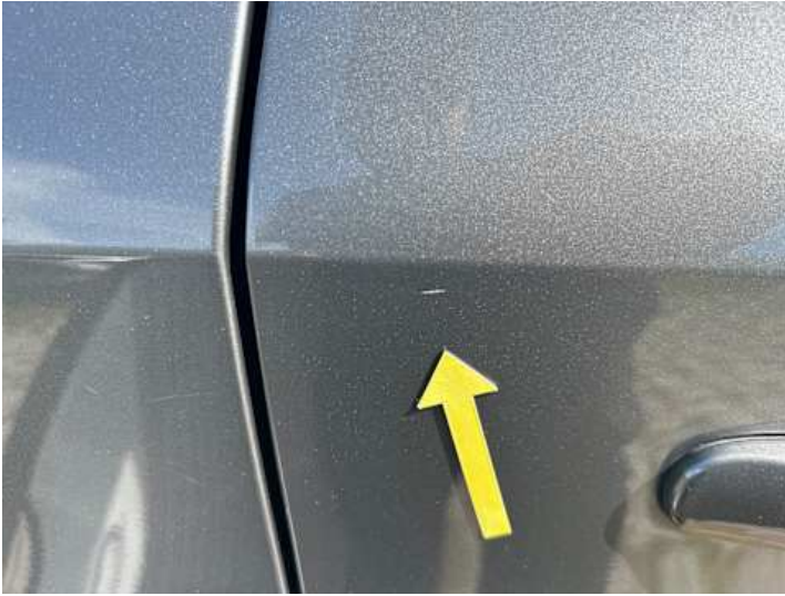
Türe hinten rechts (Lackschaden)
