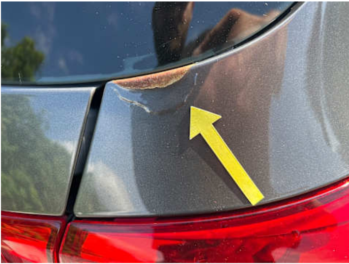
Seitenteil hinten rechts (Lackschaden, Rost)
