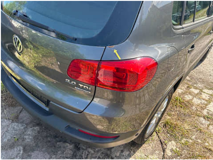
Seitenteil hinten rechts (Lackschaden, Rost)
