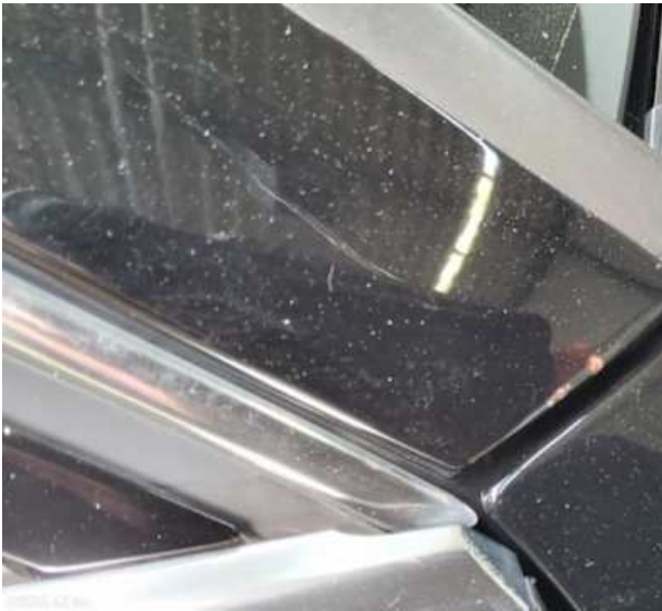
Dach (Lackschaden, Kratzer)
