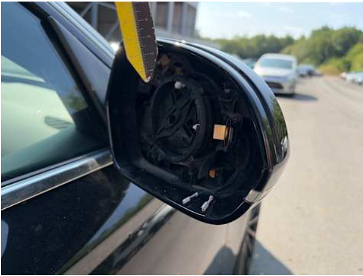
Beifahrertür (Anderer Schaden): Spiegelglas fehlt
