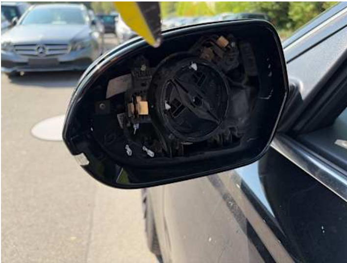
Fahrtür (Anderer Schaden): Spiegelglas fehlt
