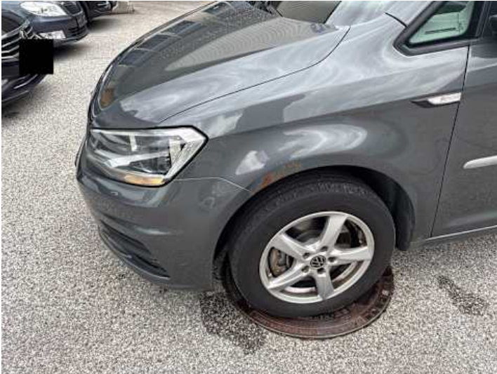
Stoßstange vorne (Lackschaden, Unsachgemäß instand gesetzt)
