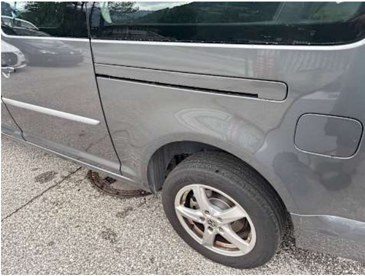
Seitenteil hinten links (Lackschaden, Rost)
