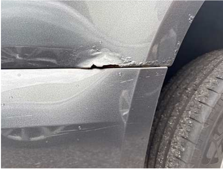
Seitenteil hinten rechts (Lackschaden, Rost)
