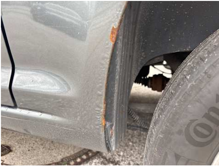
Seitenteil hinten links (Lackschaden, Rost)
