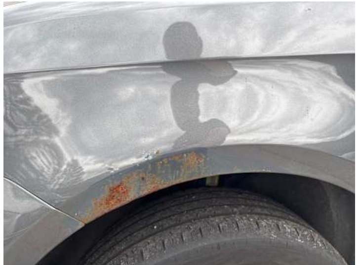
Kotflügel vorne links (Lackschaden, Rost, Unsachgemäß instand gesetzt)
