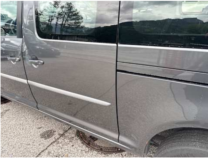
Türe hinten links (Delle)
