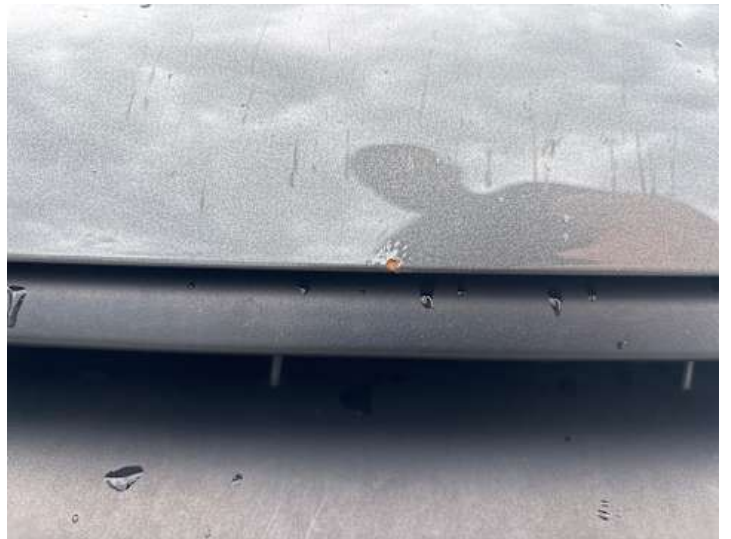
Motorhaube (Lackschaden, Rost)
