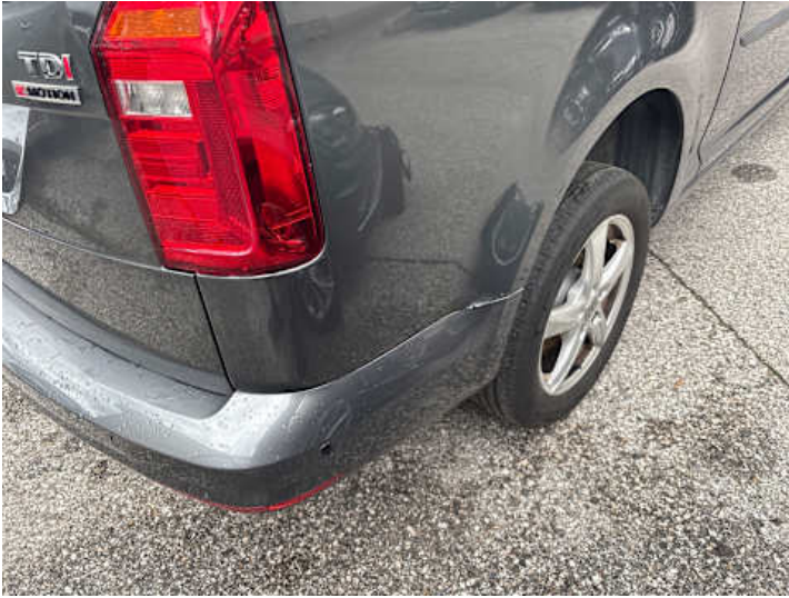
Seitenteil hinten rechts (Lackschaden, Rost)
