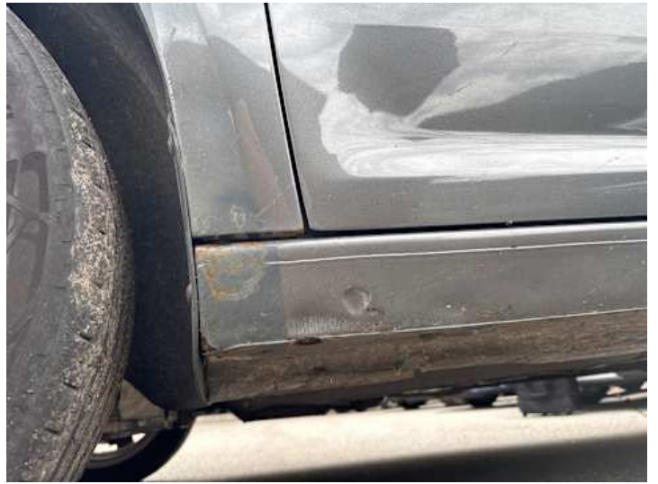
Schweller links (Rost, Unsachgemäß instand gesetzt, Verformung)
