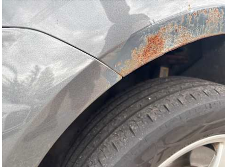
Stoßstange vorne (Lackschaden, Unsachgemäß instand gesetzt)
