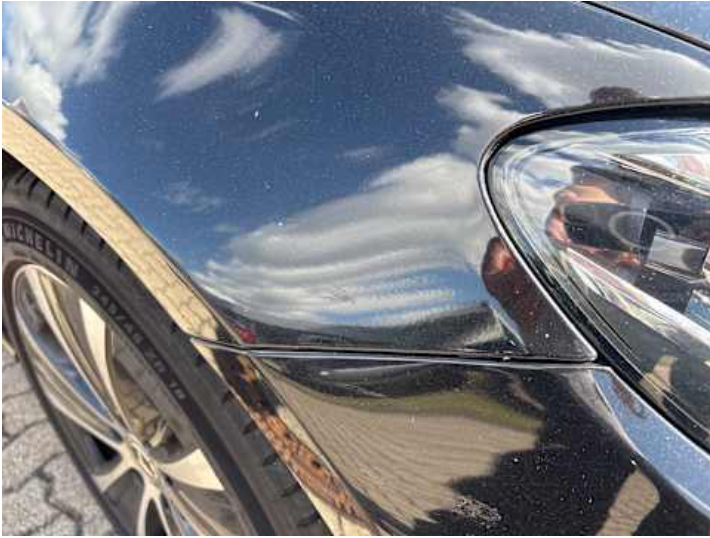
Kotflügel vorne rechts (Steinschlag)
