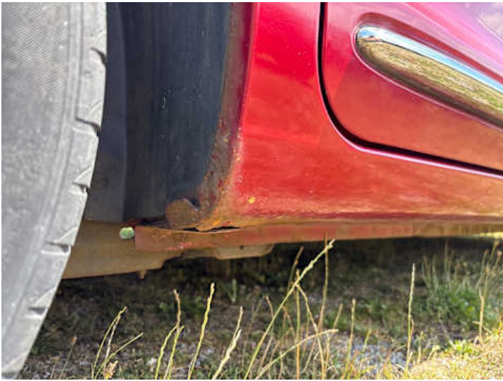
Schweller rechts (Rost, Lackschaden)
