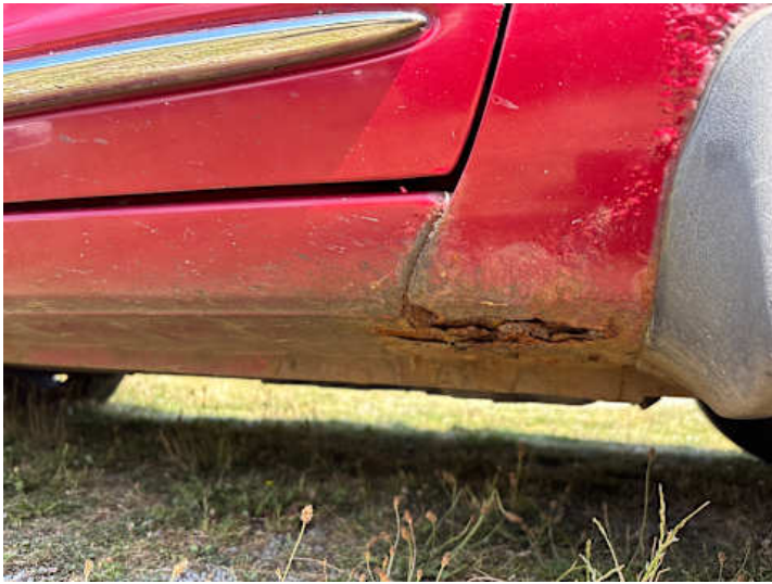
Schweller rechts (Rost, Lackschaden)
