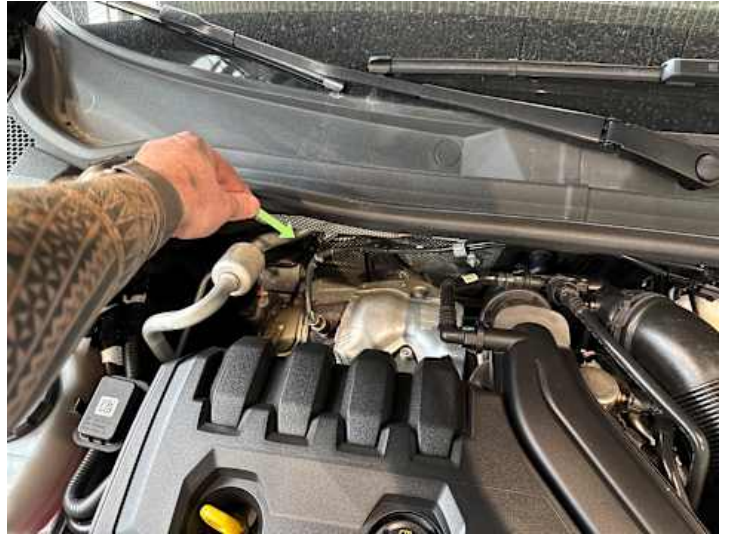
Motorhaube (Anderer Schaden): Marderschaden
