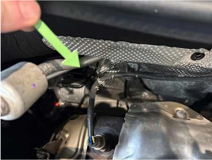
Motorhaube (Anderer Schaden): Marderschaden
