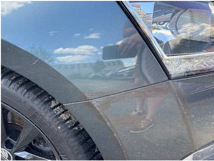
Kotflügel vorne rechts (Kratzer, Unsachgemäß instand gesetzt)
