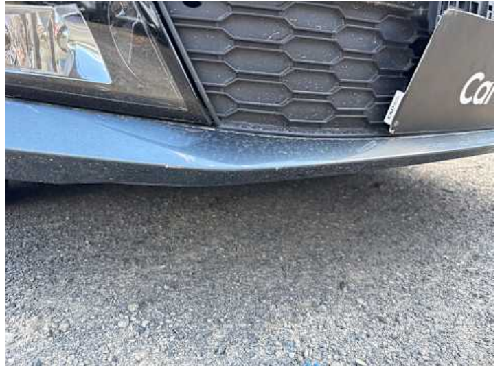
Stoßstange vorne (Kratzer, Unsachgemäß instand gesetzt)
