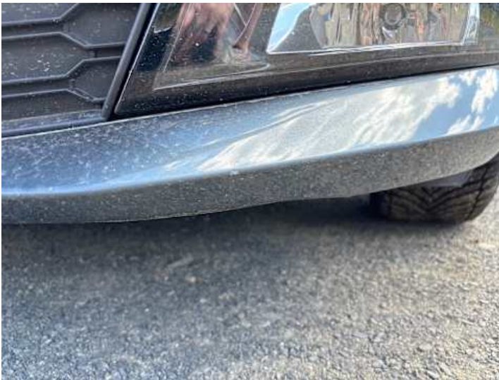
Stoßstange vorne (Kratzer, Unsachgemäß instand gesetzt)
