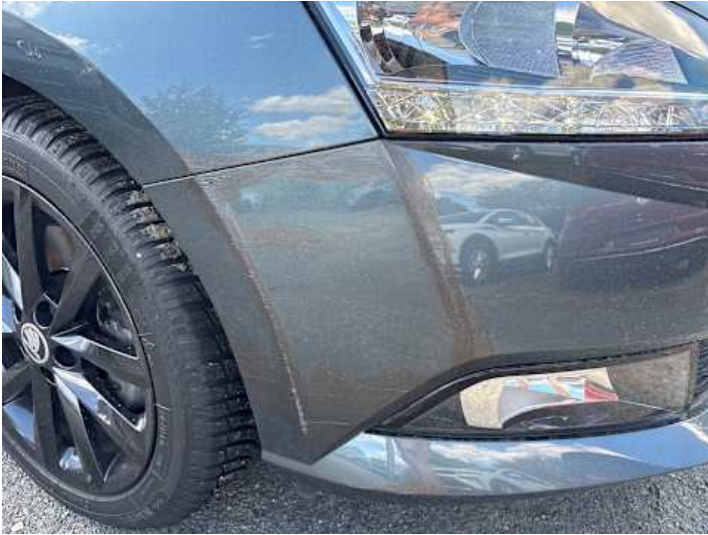
Stoßstange vorne (Kratzer, Unsachgemäß instand gesetzt)
