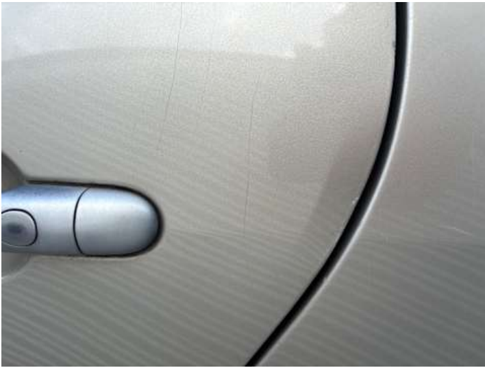
Türe hinten links (Verformung)
