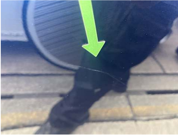
Türe hinten rechts (Kratzer, Lackschaden)
