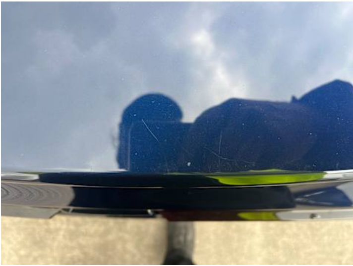
Heckklappe (Kratzer, Lackschaden)
