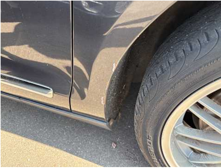
Kotflügel vorne rechts (Rost)
