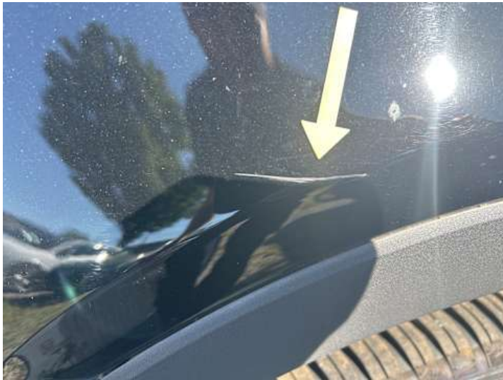
Kotflügel vorne links (Kratzer, Lackschaden)
