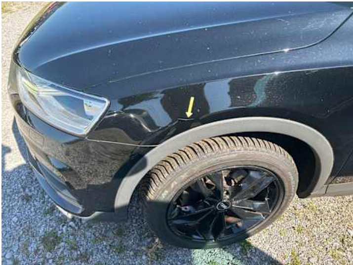
Kotflügel vorne links (Kratzer, Lackschaden)
