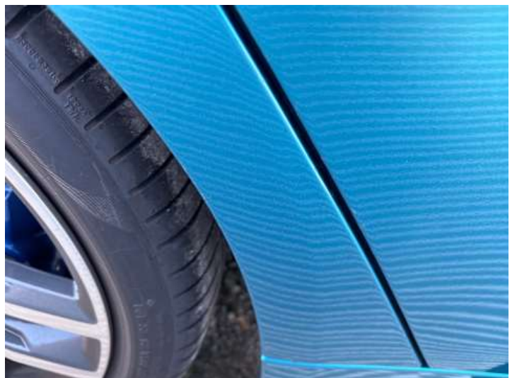
Seitenteil hinten rechts (Unsachgemäß instand gesetzt)
